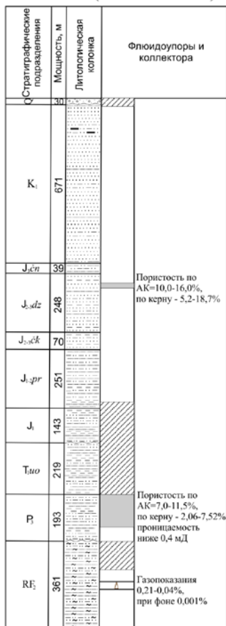
Схематический разрез Говоровской скважины (лист R-51-XVIII)
