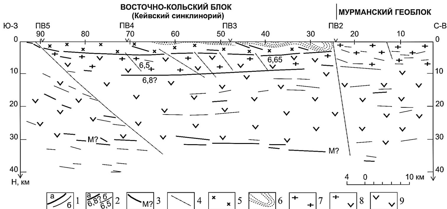
**Рис. 19. Сейсмогеологический разрез по профилю Кейвы (по материалам: И. В. Литвиненко и др.)**
