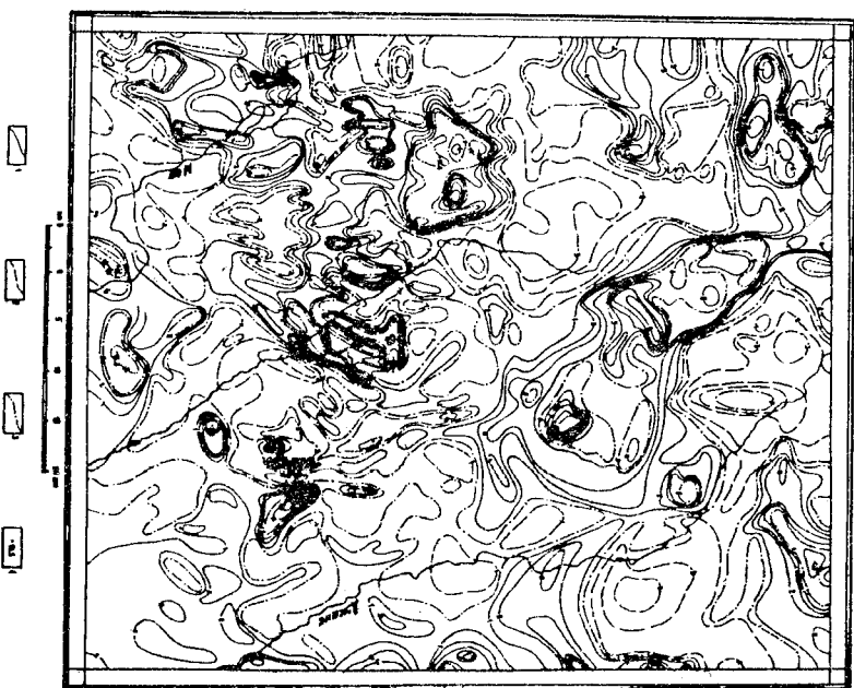
Рис. 1. Карта аномального магнитного поля (изолинии ΔTа). Масштаб 1:500 000
