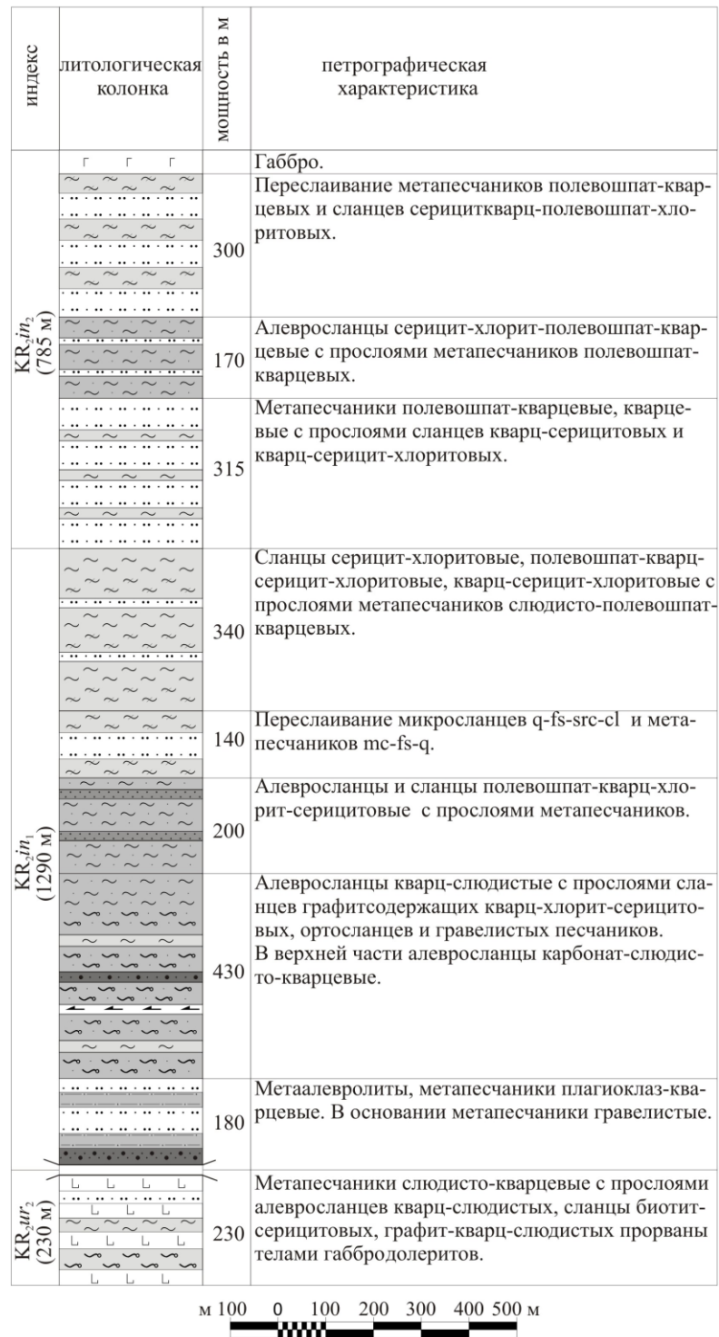
Рис. 5. Литолого-стратиграфический разрез ингашинской свиты.
