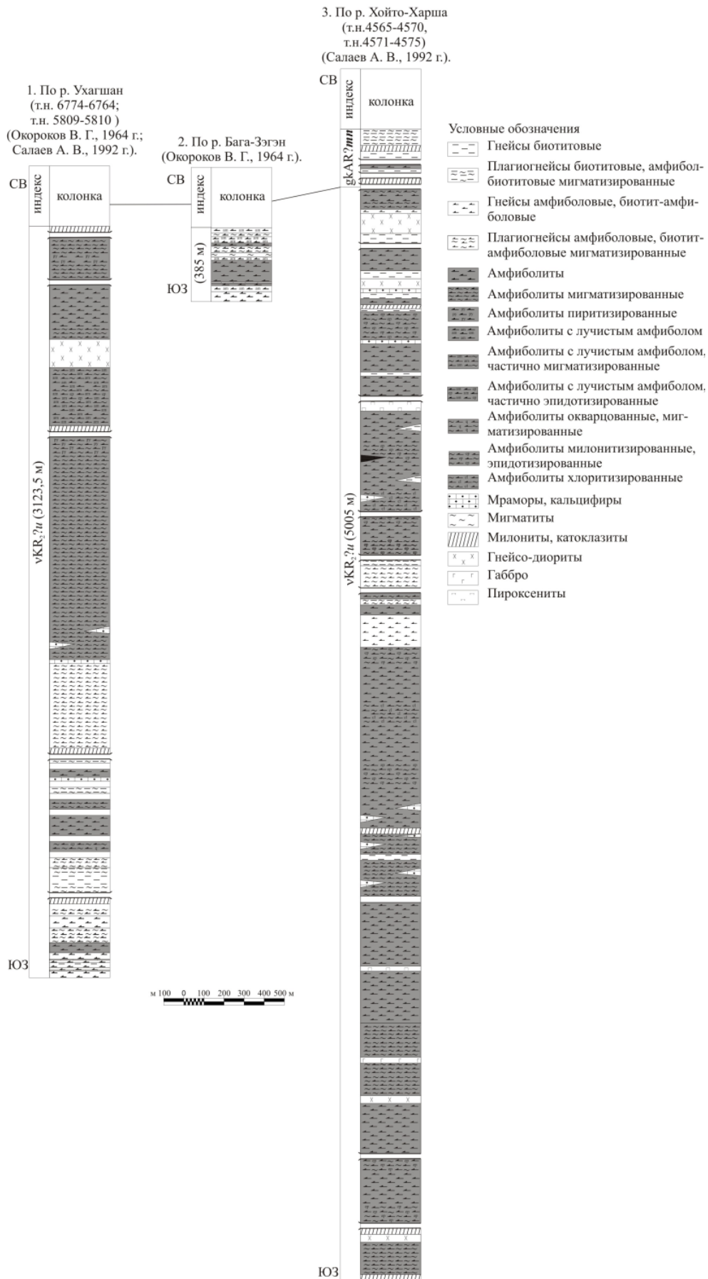
Рис. 11. Последовательность чередование пород в пределах урдаокинского комплекса.
