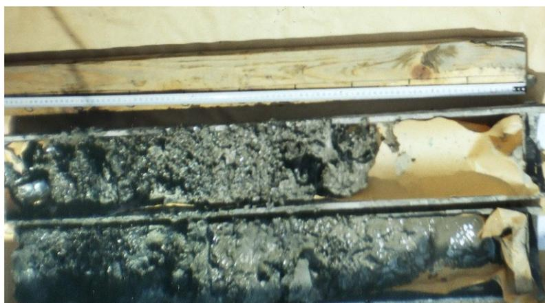
Рис. 12. Проба 366-1. Сопочная брекчия с нефтью с грязевого вулкана Нефтяного.
