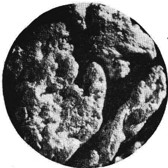
Рис. 1.19. Внешний вид сростаний изомертнита (темно-серое) и самородного золота в четвертичной россыпи на Полярном Урале. \times 25 .
