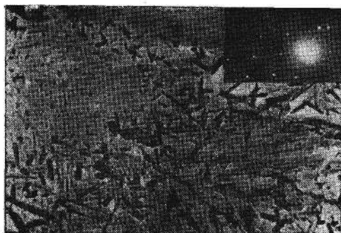
Рис. 1.27. Микровключения джемсонита в пирите. Верхнеаршинское месторождение. \times 12\,000 . На вклейке — электронограмма от плоскости (310) джемсонита. Материалы Т. И. Ширококовой.
