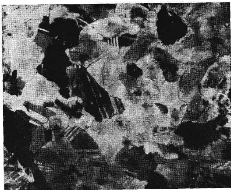
Рис. V.15. Карналлит-галитовая порода со сдвойникованными зернами карналлита. Верхнекамское месторождение, пласт Е. Ник. +; \times 2,5 . Материалы М. Л. Вороновой.
