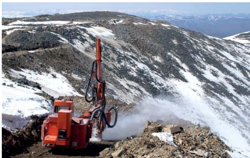
Проходка разведочных траншей с применением БВР на небольшом жильном объекте
