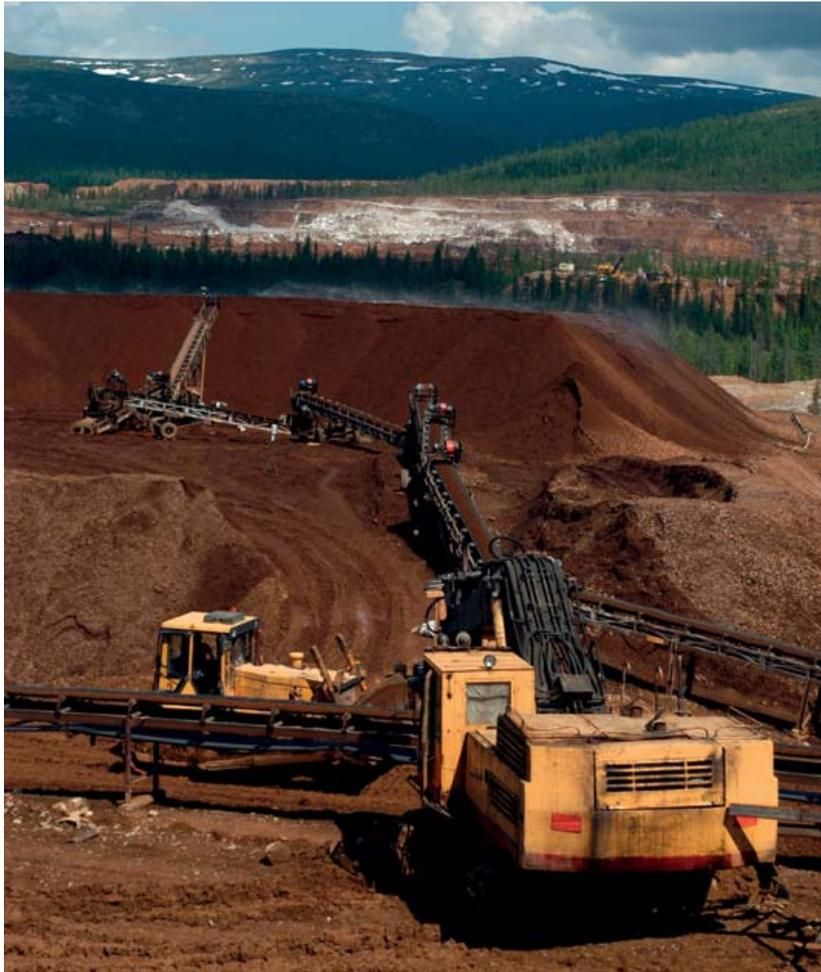
Рис. 7. Укладка штабеля параллельно с началом его орошения, «Золото Селигдара», Якутия.
