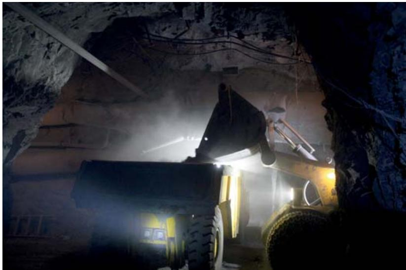
Рис. 5. Погрузка породы при проходке автотранспортного уклона
