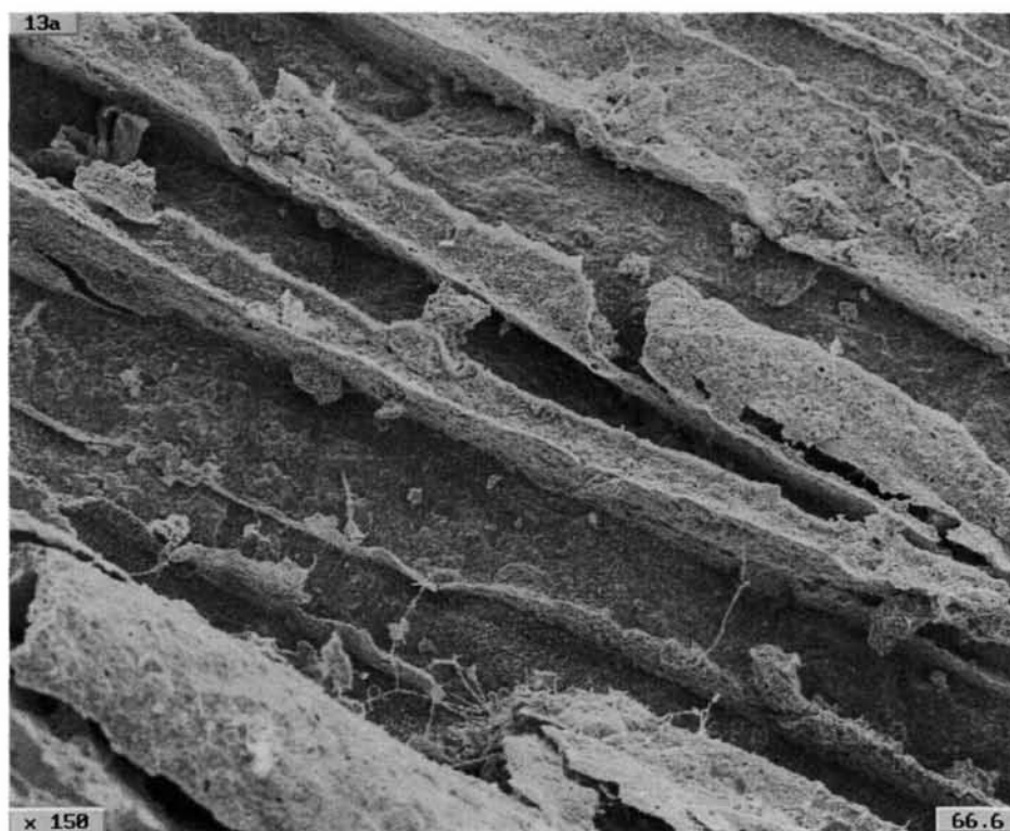
Рис.3.1 Электронномикроскопические снимки свежего скола битуминозного силицита с микротрещинной пустотностью, подчеркнутой выделениями серы. Увеличение: а) 50х; б) 150х (Сахалинское месторождение, скв.20, пласт ЮС 0 , нтервал 3003,5-3016 м, 3.45 м от кровли интервала).
