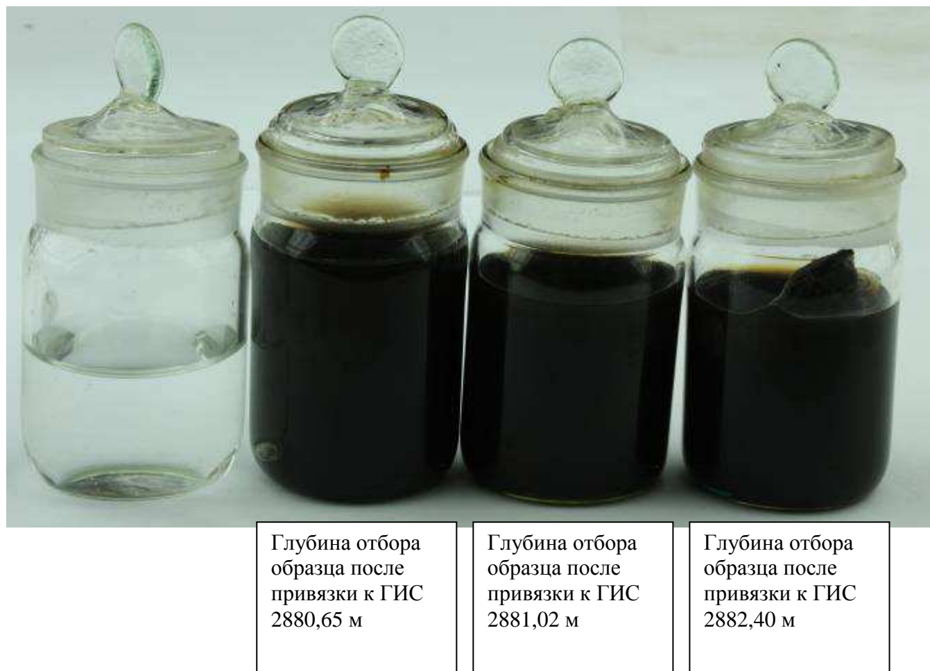
Рис. 4.16. Спиртобензольная вытяжка образцов Вынгапуровского месторождения. Слева экспонируется бюкс с чистой спиртобензольной смесью.
