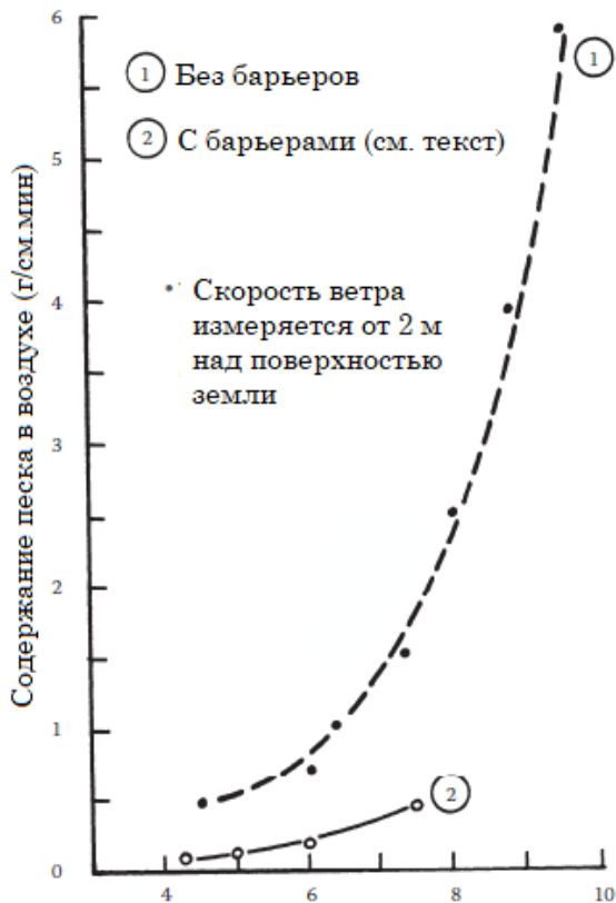
Рисунок 18.19. Сравнение содержания песка в воздухе: (1) без барьеров и (2) с барьерами (по Chu, P. C., et al. [2008], Environ. Int. v. 34, pp. 698–713).
