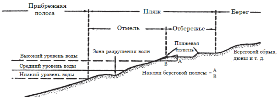
Рисунок 14.2. Схематическое изображение элементов прибрежной окраины (по Beach Erosion Board [1963], Annual Bulletin of the Beach Erosion Board, Department of the Army, Corps of Engineers, v. 17, July, 99p. Этот материал является собственностью правительства США, но находится в открытом доступе и не подлежит защите авторских прав).
