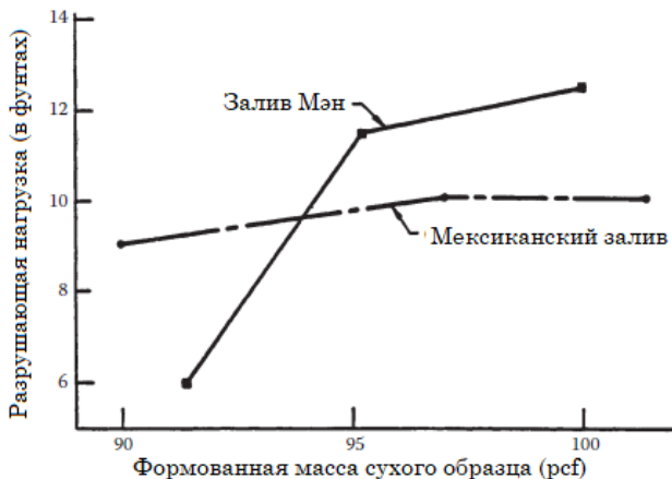
Рисунок 6.23. Нагрузка на разрыв против веса формованных сухих образцов глины с залива штата Мэн и Мексиканского залива (по Fang, 1994a, Proc. Int. Symp. on Pre-failure Deformation Characteristics of Geomaterials, Japan, S. Shibuya, T. Mitachi and S. Miura, eds. pp. 299–304. С разрешения ASCE).
