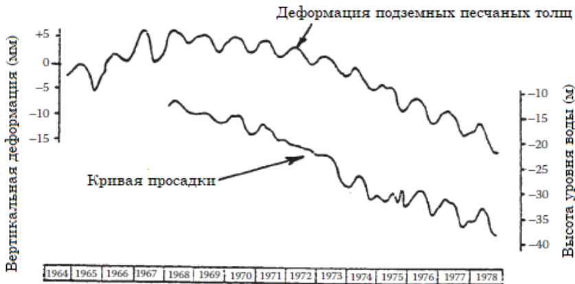
Рисунок 15.7. Влияние закачки на характеристики деформации подземных песчаных толщ в районе залегания шанхайской мягкой глины (по Su, H. Y., [1979], Chin. J. Geotech. Eng., v. 1, n. 1, pp. 24–35. С разрешения CAS).
