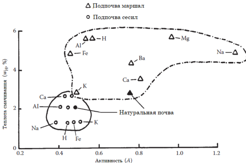
Рисунок 5.10. Сравнение теплоты смачивания и активности естественных и гомоионных почв (данные из: Winterkorn [1942], Soil Sci., v. 54, pp. 259–273 and Table 4.8).
