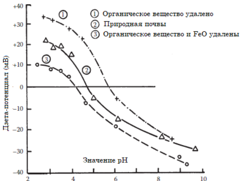
Рисунок 9.22. Влияние значения pH на дзета-потенциал латеритной почвы при различных условиях окружающей среды (по Chiang and Shen [1962]; cited by Yu, T. Y. and Chiang, H. Y. [1984], Electro-Chemical Properties of Soils , Scientific Publ. Co., Beijing. [На китайском]).
