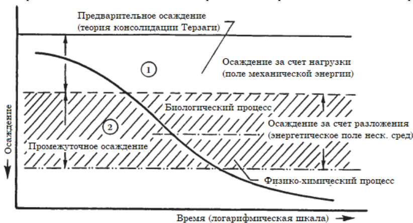
Рисунок 11.14. Схематическая диаграмма, иллюстрирующая осадание в зависимости от времени для разлагаемого материала.
