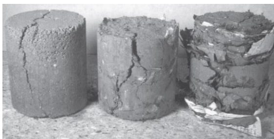
Рисунок 17.6. Подготовленный лабораторией материал для удаления отходов для стабилизации почвы (слева направо: 100 %, 83 % и 75 % почвы по массе).
