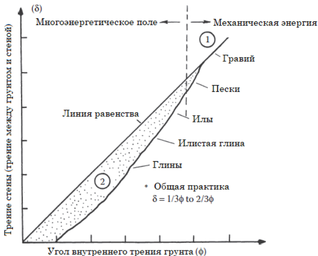
Рисунок 12.12. Угол трения между почвами (φ) в зависимости от угла трения между почвой и стеной (δ).
