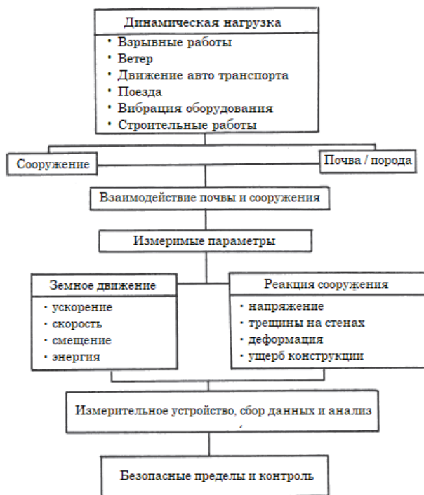
Рисунок 12.6. Обобщение взаимодействия грунта и сооружения при динамическом нагружении и измеримые параметры.
