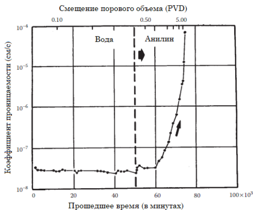
Рисунок 7.12. Влияние поровой жидкости на проницаемость песчано-бентонитовой смеси (по Evans J. C. and Fang, H. Y. [1988], Triaxial permeability and strength testing of contaminated soils, ASTM STP 977, pp. 387–404).
