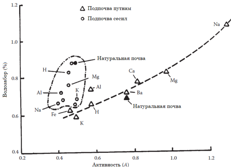
Рисунок 5.12. Водопоглощающая способность в зависимости от активности (сравнение естественной и гомоионной почв) (данные из таблицы 4.8).
