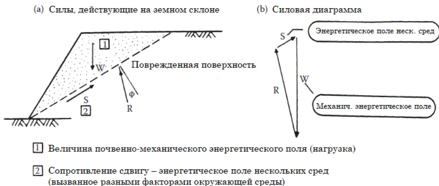
Рисунок 16.3. Концепция предельного равновесия для анализа устойчивости склона: (a) силы, действующие на склон земли и (b) диаграмма сил.
