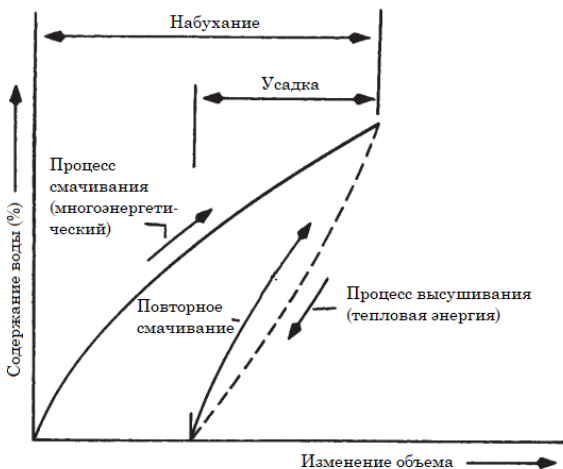
Рисунок 6.1. Схема иллюстрирует связь между процессами усадки и набухания.
