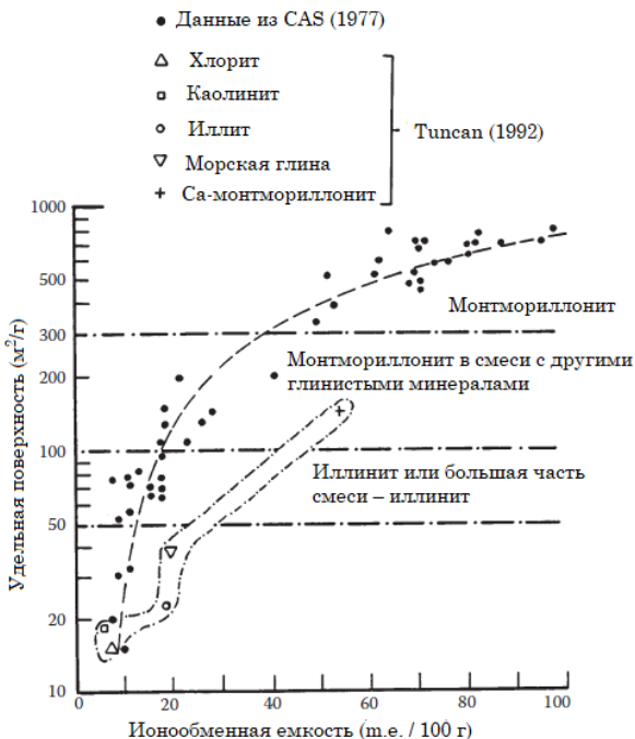
Рисунок 4.8. Удельная поверхность по сравнению с ионообменной емкостью (из: Fang, H. Y. [1997], Introduction to Environmental Geotechnology, CRC Press, Boca Raton, FL, 652 p.).
