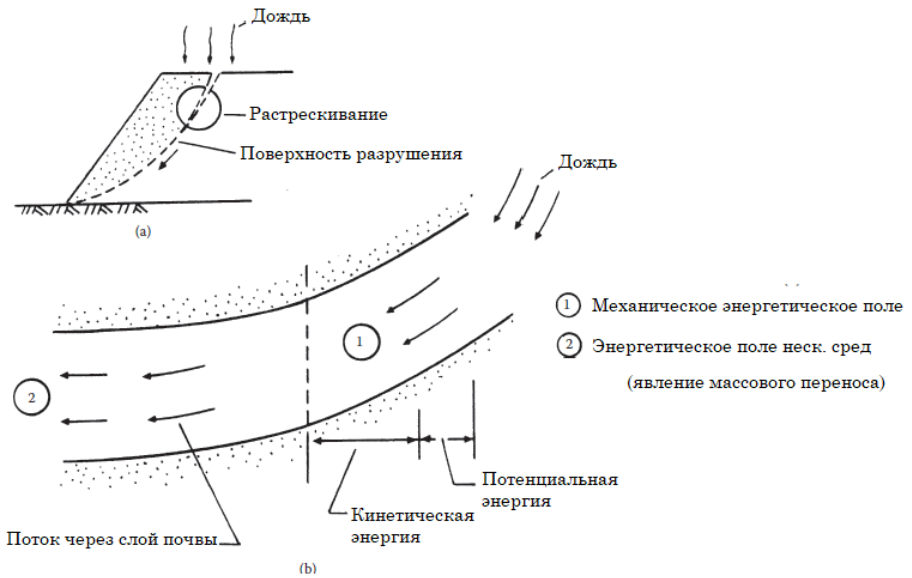
Рисунок 16.6. Механизм разрушения склона, вызванный ливнем и связанный с различными силовыми полями: (a) общий вид и (b) вид крупным планом.
