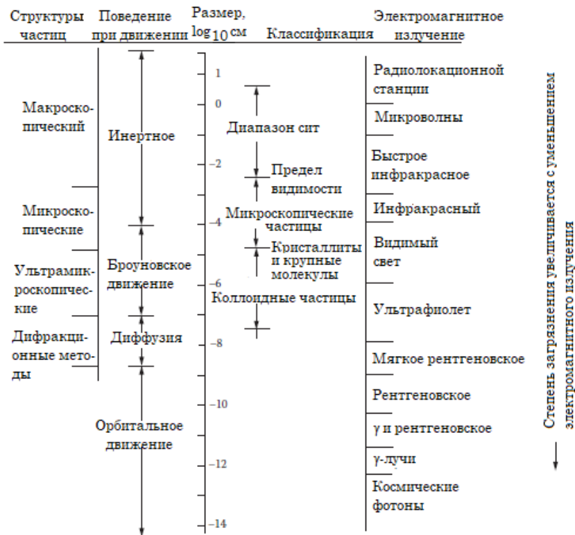
Рисунок 2.7. Размеры частиц почвы, их поведение при движении и методы измерения (по Freudenthal [1950], [на немецком]; см.: Winterkorn, H. F. [1974], Notes on Construction Materials, Department of Civil and Geological Engineering, Princeton University, Princeton, NJ).
