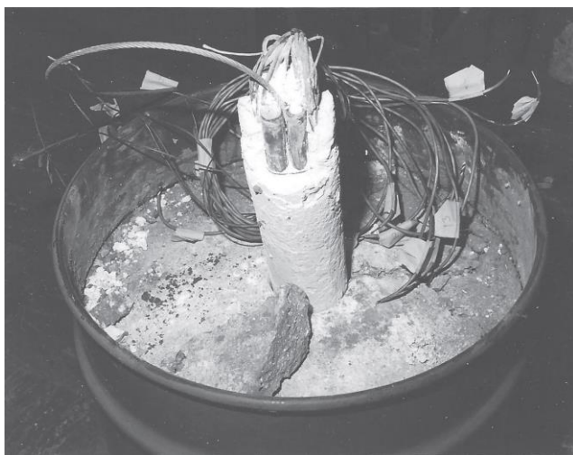
Рисунок 16.16. Бамбуково-известковые композитные сваи.
