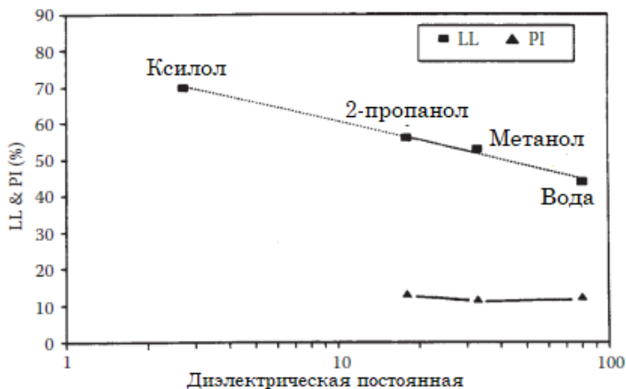
Рисунок 9.12. Аттерберговский предел растворителей как функция диэлектрической проницаемости (по Kaуa, A. and Fang, H. Y. [1996], ASTM STP 1282, pp. 303–314).
