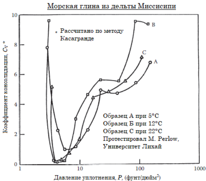
Рисунок 14.5. Влияние температуры на коэффициент уплотнения глины из дельты Миссисипи (протестировано М. Perlow из Университета Лихай).
