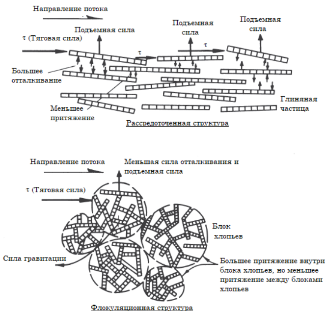
Рисунок 14.7. Влияние глинистых структур на равновесие почвы под проточной водой (по Liou, Y. D. [1970], Hydraulic erodibility of two pure clay systems, Ph.D. dissertation, Department of Civil Engineering, Colorado State University, Fort Collins, CO).
