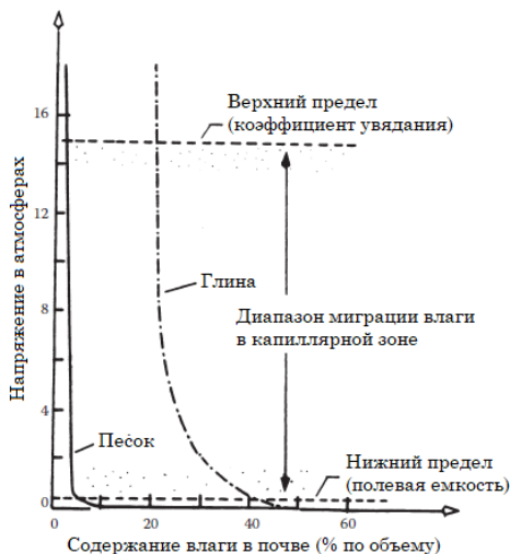
Рисунок 7.19. Верхние и нижние ограничения для миграции влаги в капиллярной зоне (данные из: Lassen, L., Lull, H. W. and Frank, B. [1952], Some plant–soil–water relations in watershed management, Circular 910, USDA, Washington, D.C.)
