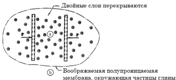
Рисунок 7.15. Осмотическое давление между двумя глинистыми частицами, погруженными в воду (по Ladd, С. С. [1960], Mechanisms of Swelling by Compacted Clay, HRB Bulletin 265, pp. 10–26. Этот материал является собственностью правительства США, но находится в открытом доступе и не подлежит защите авторских прав).
