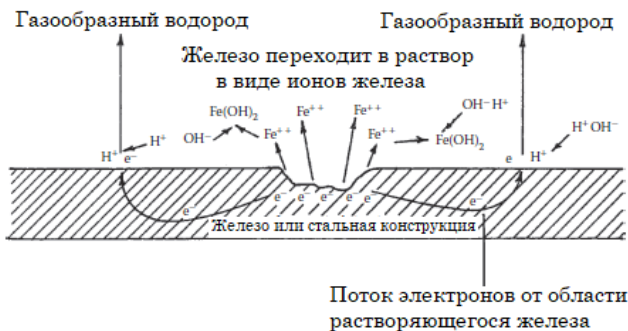
(a) Процесс коррозии железных или стальных элементов конструкции
