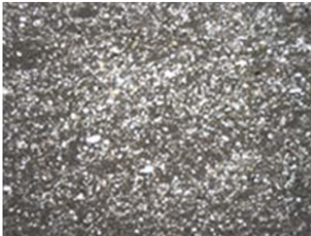
Рис. 26. Известняк фораминиферовый глинистый алевритистый биотурбированный с обильным пелитоморфным карбонатом. Николи //, x 2,5. Фото Г.В. Агафоновой.
