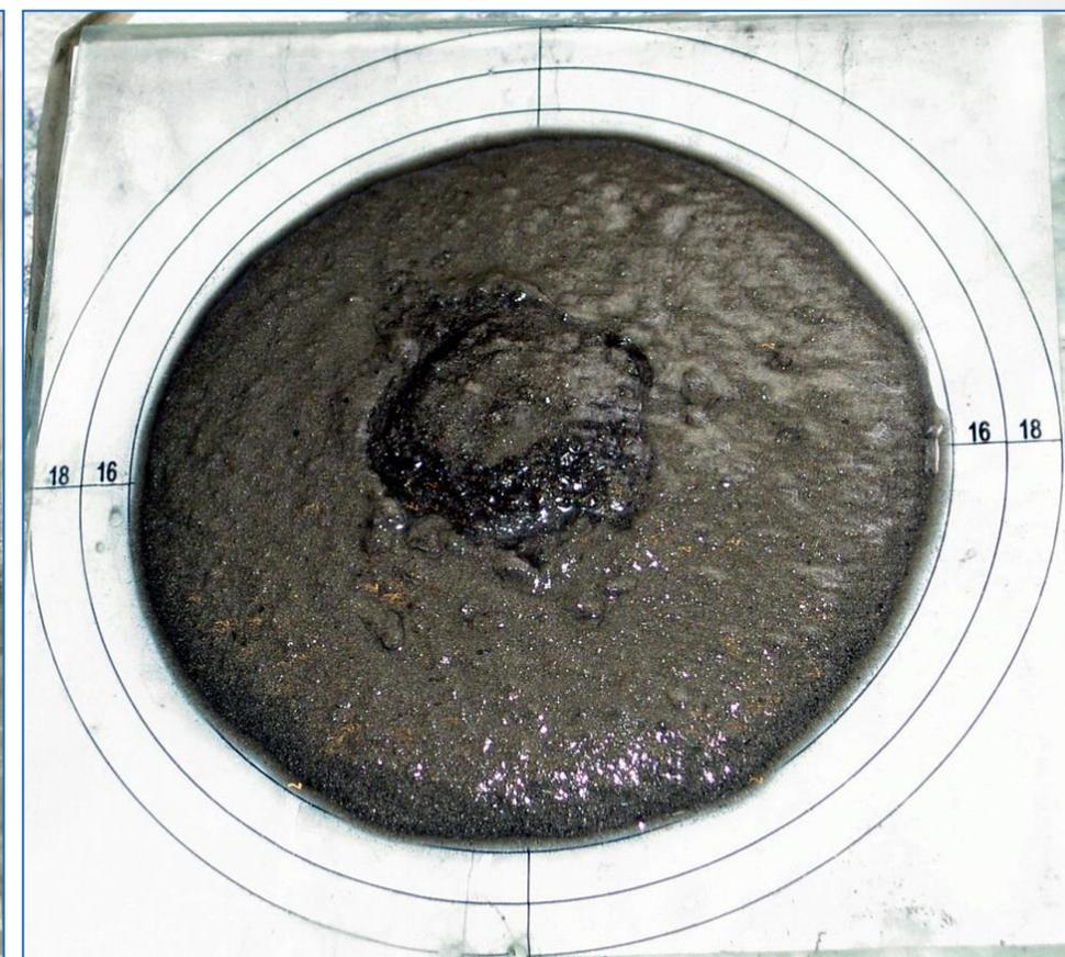
*Определение подвижности смеси по распылу на стекле вискозиметром Суттарда (ГОСТ 125-79)*
