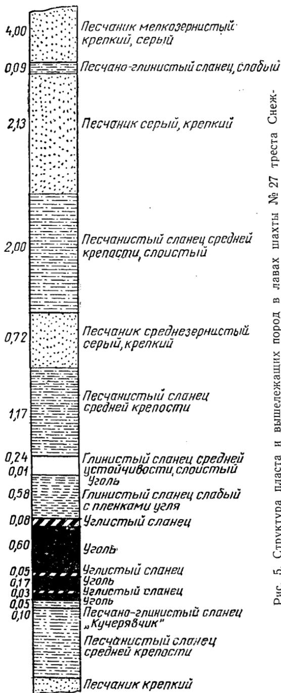
Рис. 5. Структура пласта и вышележащих пород в лаве шахты № 27 треста Снежинянантрацит (Донбасс)
