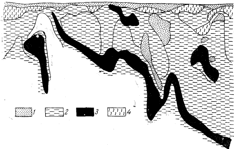
Рис. 74. Геологический разрез месторождения Стоне 1 — песок; 2 — глина; 3 — уголь; 4 — суглинок
