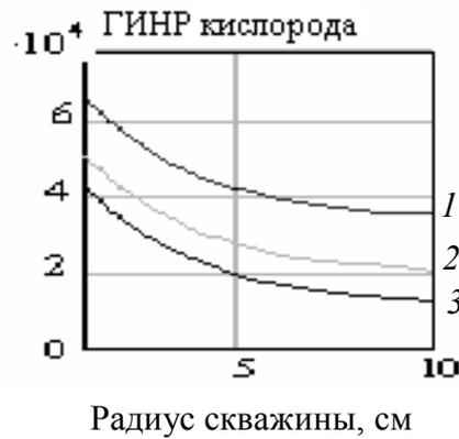
Рис. 7.7.6. Зависимость потока ГИНР кислорода от радиуса скважины  $r_0$ , см: длина зонда  $z = 15$  см (1);  $z = 20$  см (2);  $z = 25$  см (3)
