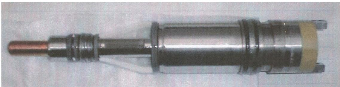
Рис. 7.6.12. Нейтронная трубка
