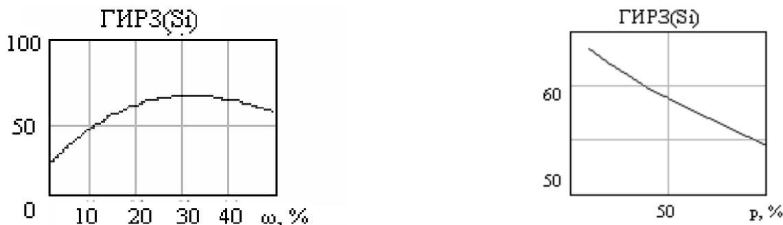
Рис. 7.7.10. Зависимость потока захватного гамма-излучения от водонасыщенной пористости пласта  $\omega, \%$  (слева) и глинистости  $p, \%$  (справа) в области малых зондов
