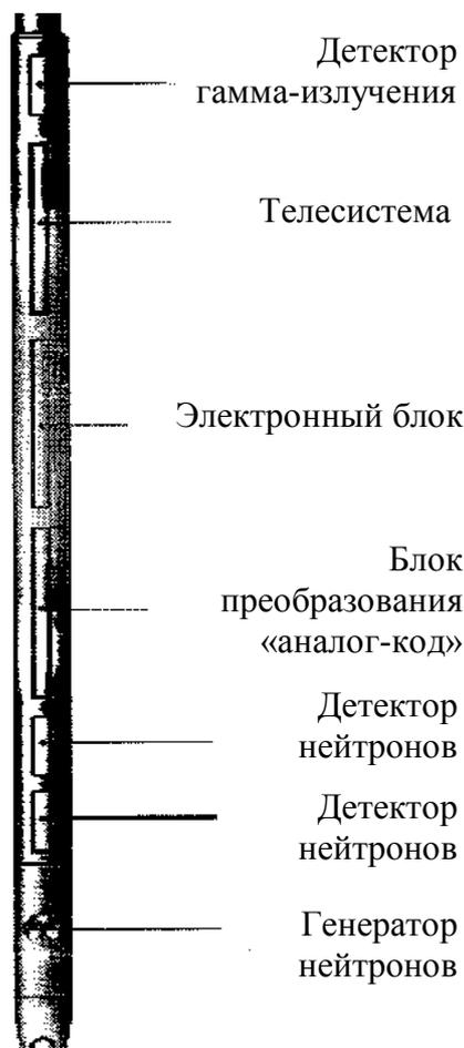
Рис. 7.6.17. Блок-схема скважинного прибора аппаратуры КНДМ (двухзондовый стандарт) [7.6.14]
