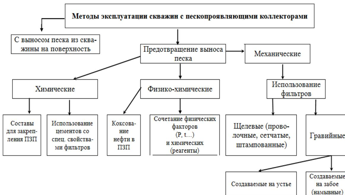
Рисунок 6 – Методы эксплуатации скважин с пескопроявляющими коллекторами
