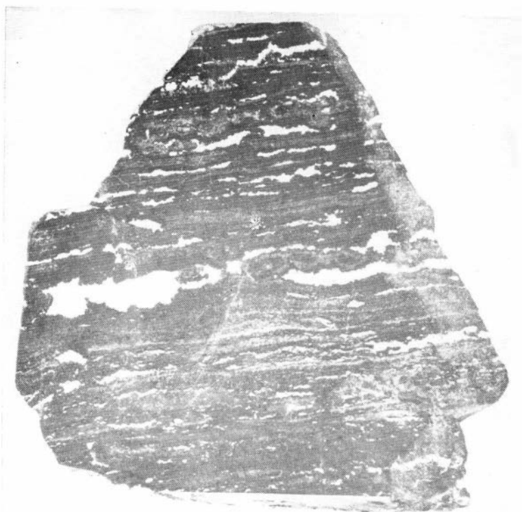
Фото 25. Субпараллельное расположение прожилковидных обособлений белого эпигенетического доломита в тонкослоистой доломит-галенит-сфалеритовой руде первой парагенетической ассоциации. В залябандах прожилковидных обособлений доломита отчетливо видны оторочки из сфалерита II (черное). Полированный штуф С-43-32 (месторождение Сардана, канава 43). 0,9 нат. вел.
