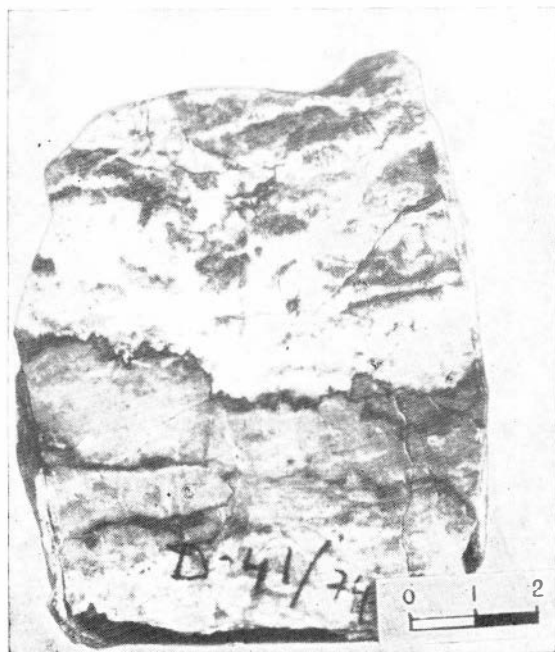
Фото 36. Порфиробластические выделения галенита III (светлое) в энгенетическом доломите III. Полированный штуф С-45-39 (месторождение Сардана, канава 45). Нат. вел.
