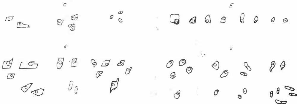
Рис. 59. Форма газово-жидких включений в доломите (а), сфалерите третьей парагенетической ассоциации (б), кальците (в) и кварце (г).
