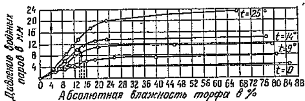
Фиг. 1а. Соотношение между упругостью водяного пара в торфе и в окружающем воздухе (по Курнакову и Пospelовой).
