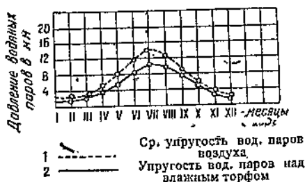
Фиг. 16. Соотношение между упругостью водяного пара в торфе и в окружающем воздухе (по Курнакову и Пospelовой).
