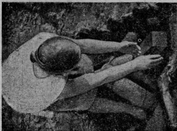
а б в Фиг. 38 а , б и в . Последовательный ход рабочих операций при укладке торфа в „змейки“.
