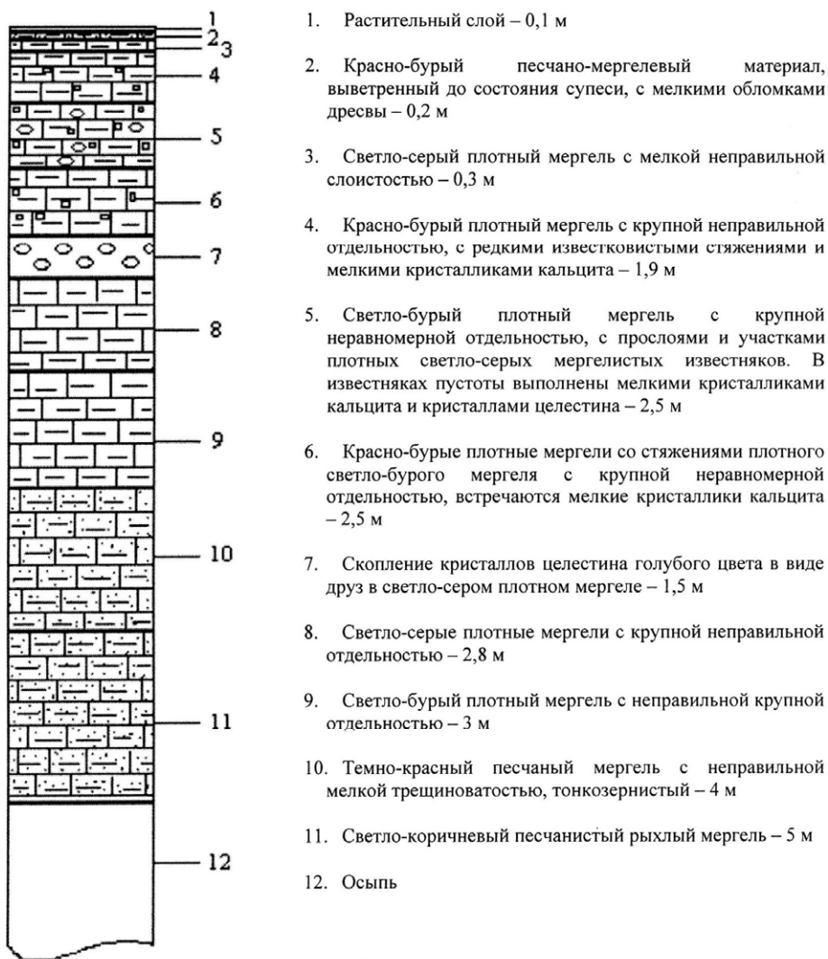
Рис. 10. Разрез Вихтовского месторождения целестина
