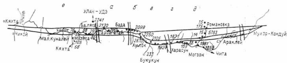
Рис. 44. Плановое положение зоны Хилокского разлома и реперов линий повторного нивелирования.
