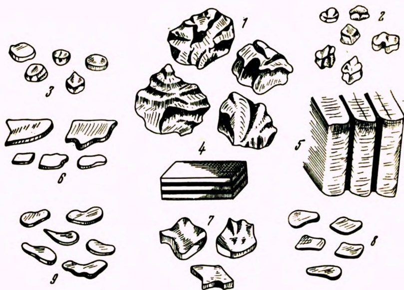
Рис. 28. Основные виды макроструктуры: 1 — глыбовая; 2 — комковатая; 3 — ореховидная; 4 — слоистая; 5 — столбчатая; 6 — плитчатая; 7 — сланцеватая; 8 — листоватая; 9 — чешуйчатая
