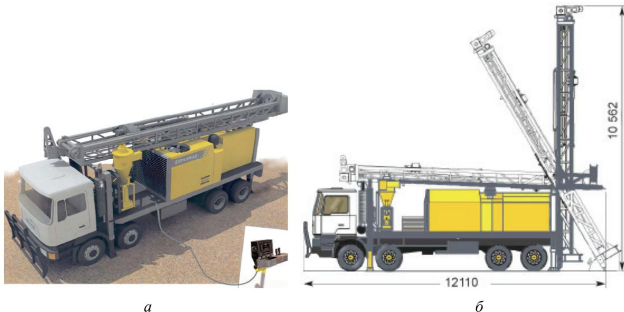
Рис. 4.20. Буровая установка *Explorac 220 RC*: а – в транспортном положении с вынесенным пультом управления; б – иллюстрация возможных вариантов установки буровой мачты
