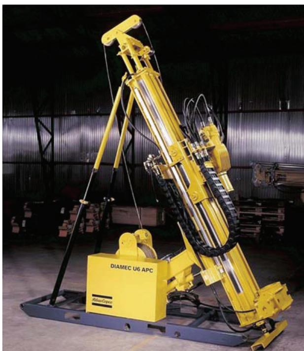
Рис. 4.15. Установка для подземного бурения *Diames U6 APC*
