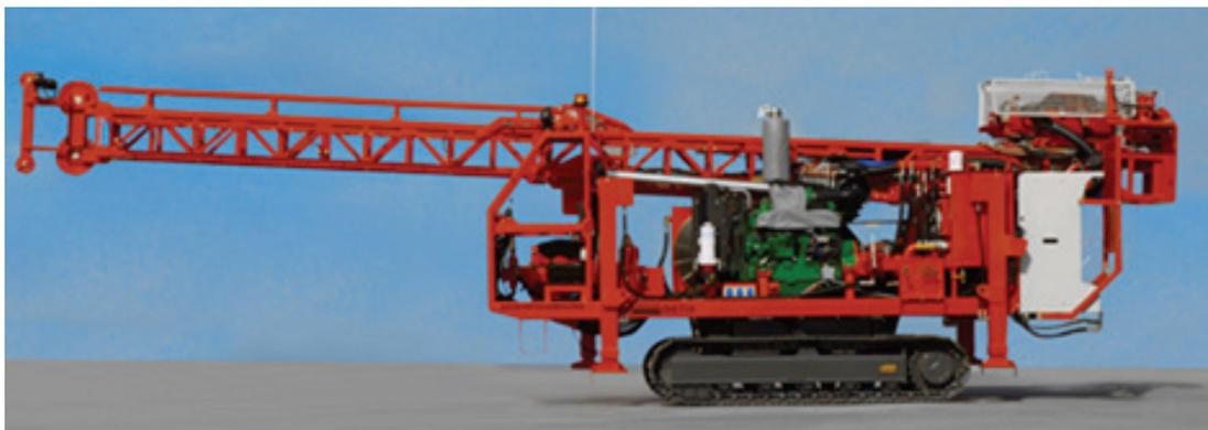
Рис. 4.24. Буровая установка DE 710 на гусеничной транспортной базе
