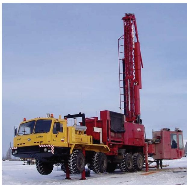
Рис. 4.27. Установка *Schramm T450*, северное исполнение (Амакинская ГРЭ АК «Алроса»)
