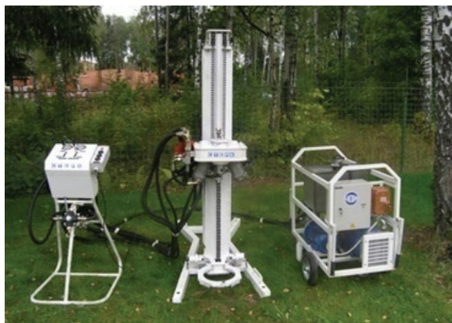
Рис. 4.5. Станок буровой гидрофицированный модульный СБГ-ПМ2 «Стерх»
