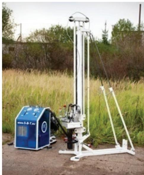
Рис. 4.4. Буровая установка СБ-ПМ «Колибри»
