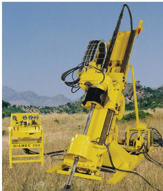
Рис. 4.13. Установка *Diamec 282B* для бурения с поверхности
