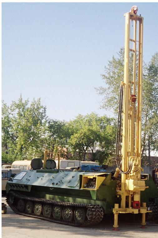
Рис. 4.3. Буровая установка УРБ-2НТ на базе ТТ
