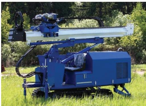
Рис. 4.6. Установка буровая типа УБГ-Л «Мангуст» на гусеничной базе
