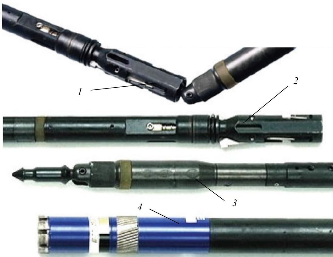
Рис. 7.2. Снаряд ССК серии *CORAC* компании *Atlas Copco*: 1 – овершот с шарниром для работы в стесненных условиях (горные выработки или в буровом здании); 2 – верх керноприемной трубы; 3 – овершот для горизонтальных скважин; 4 – наружная труба с коронкой и расширителем
