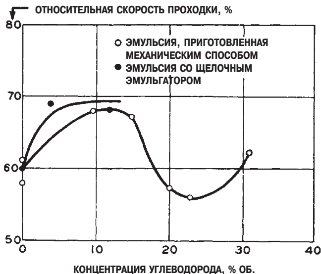
Рис. 29 — Промысловые данные, демонстрирующие влияние концентрации углеводорода в эмульсии на скорость проходки; район западного Техаса.
