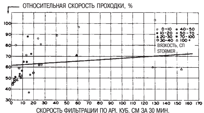
Рис. 13 — Лабораторные данные, демонстрирующие влияние скорости фильтрации на скорость проходки.
