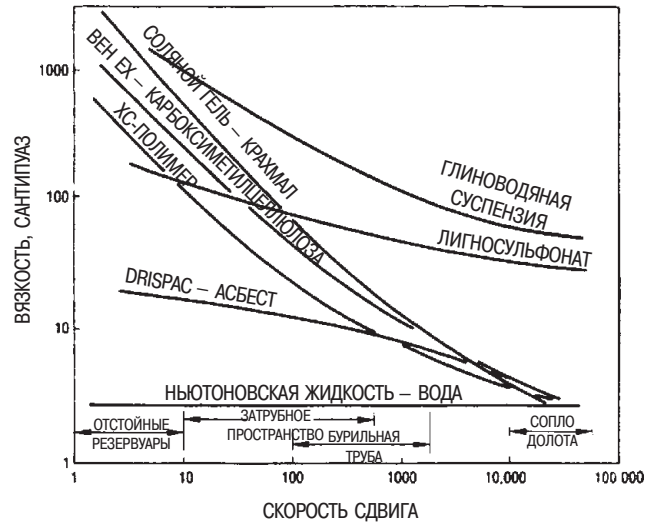
Рис. 10 — Разжижение при сдвиге различных буровых растворов.
