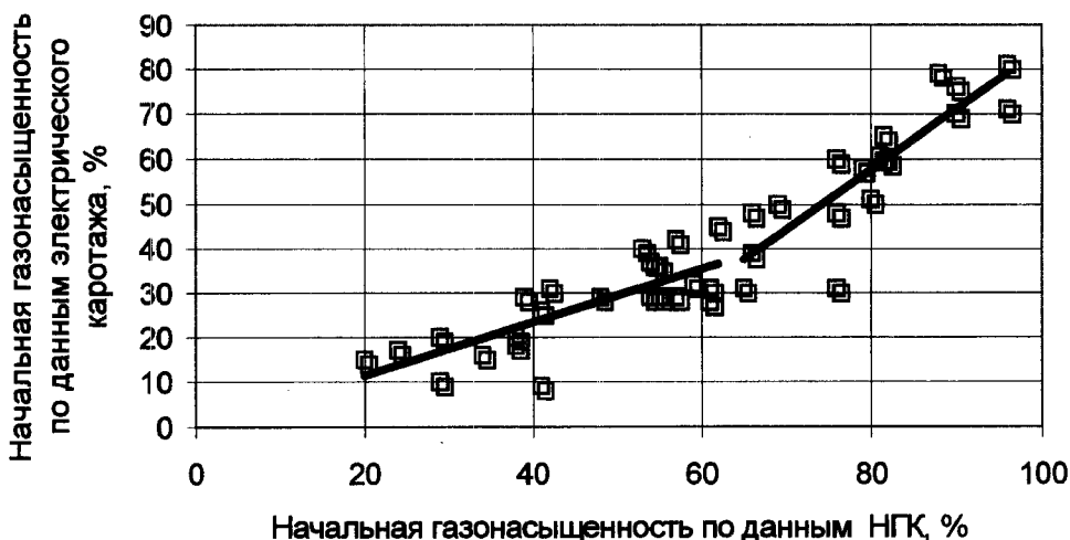
Рис.7. Сопоставление значений начальных коэффициентов газонасыщенности, полученных по данным НПК и электрического каротажа.
