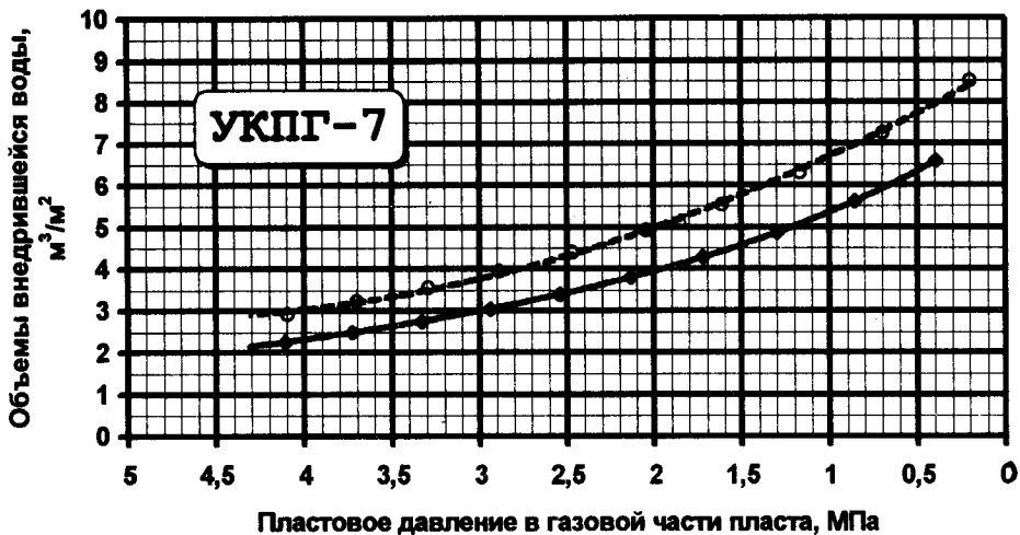
Рис.49. Прогнозные объемы внедрения подошвенной воды в \text{м}^3 на \text{м}^2 поверхности ГВК в зависимости от пластового давления в газовой части пласта по УКПГ-7 Уренгойского месторождения
