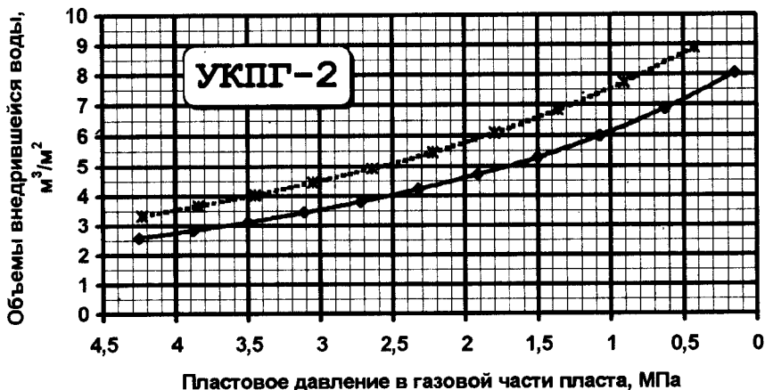
Рис.44. Прогнозные объемы внедрения подошвенной воды в \text{м}^3 на \text{м}^2 поверхности ГВК в зависимости от пластового давления в газовой части пласта по УКПГ-2 Уренгойского месторождения
