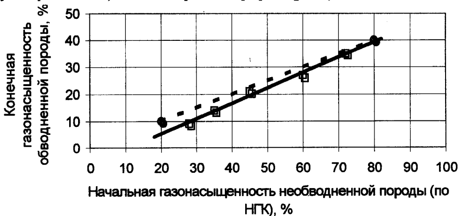
Рис.8. Сопоставление зависимости коэффициента конечной газонасыщенности от коэффициента начальной по данным работы [13] с аналогичной зависимостью, полученной авторами книги
