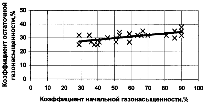
Рис.19. Зависимость коэффициента остаточной газонасыщенности от значений начальных коэффициентов газонасыщенности для наблюдательной скважины №140-Н (по данным ГПУ "Уренгойгаздобыча")
