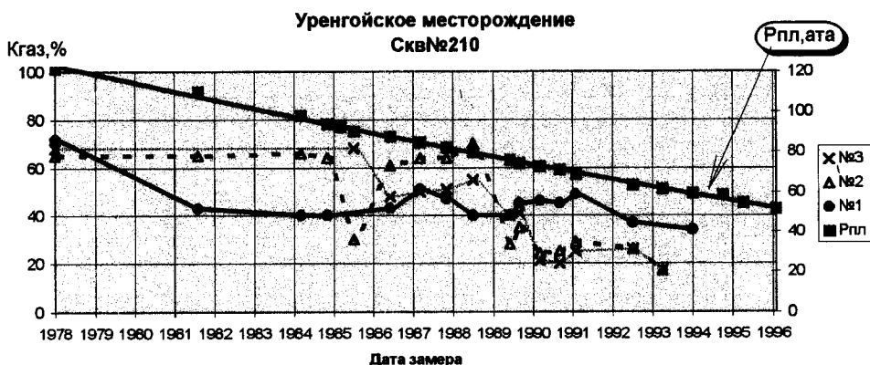
Рис.16. Изменение газонасыщенности до и после обводнения по трем пропласткам в наблюдательной скважине №210 Уренгойского месторождения (данные ГПУ"Уренгойгаздобыча")
