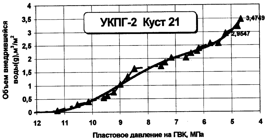
Рис.30. Объемы внедрившейся воды q м 3 на м 2 поверхности первоначального ГВК по скв.№210-Н Уренгойского месторождения
