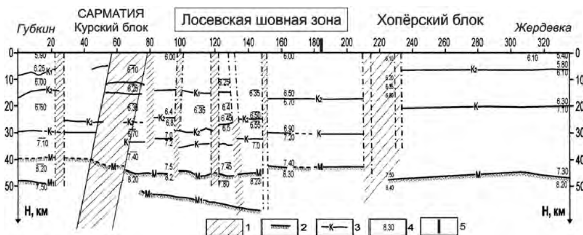
Рис. 3.12. Сейсмический разрез литосферы по профилю ГСЗ Губкин–Жердевка по (Афанасьев и др., 2012): 1 – зоны глубинных разломов; 2 – границы Мохоровичича и в верхах мантии; 3 – внутрикоровые сейсмические границы; 4 – значения скорости продольных волн, км/с (с чертой – пластовые скорости, без черты – скорости над и под границей)
