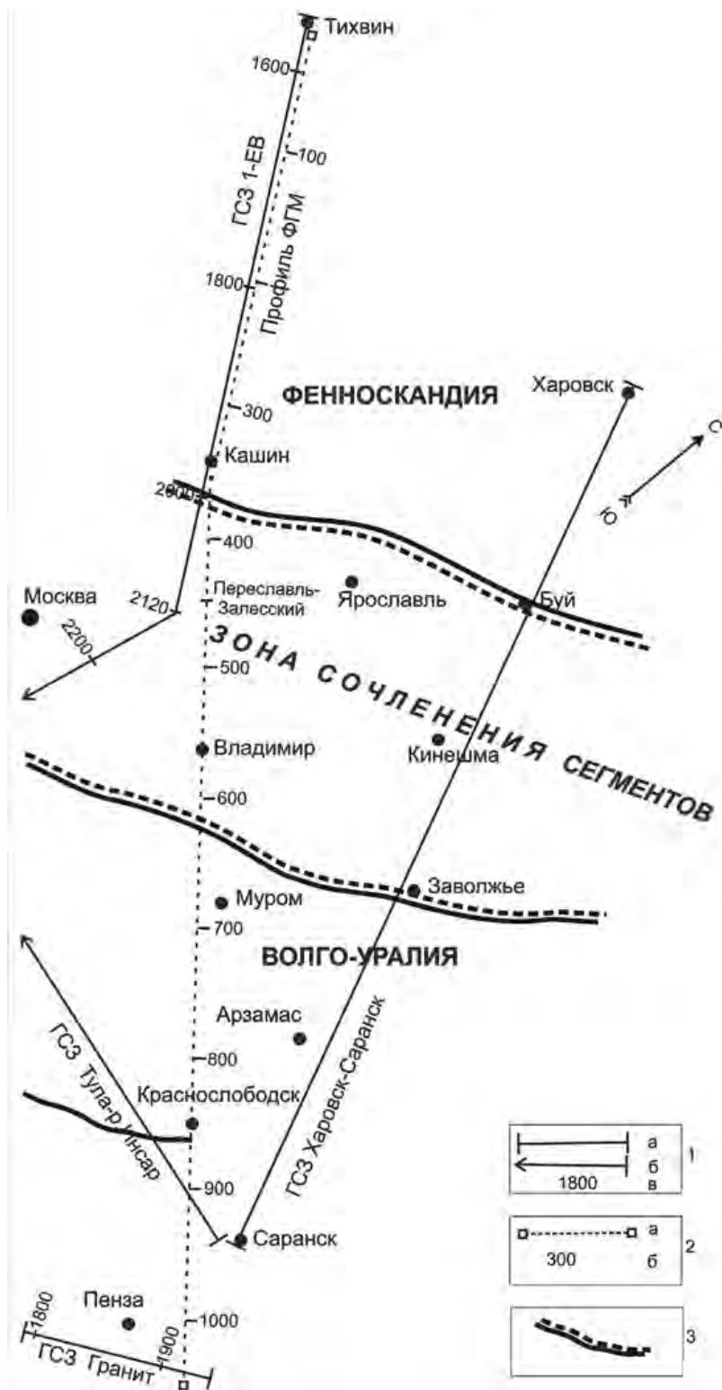
Рис. 4.1. Схема геотраверсов глубинных сейсмических зондирований (ГСЗ) и профиля физико-геологического моделирования (ФГМ) в зоне сочленения сегментов Фенноскандии и Волго-Уралии: 1 – геотраверсы ГСЗ: а – полные, б – фрагменты, в – сейсмические пикеты, км; 2 – а – профиль ФГМ, б – километраж; 3 – границы Центральнорусской шовной зоны
