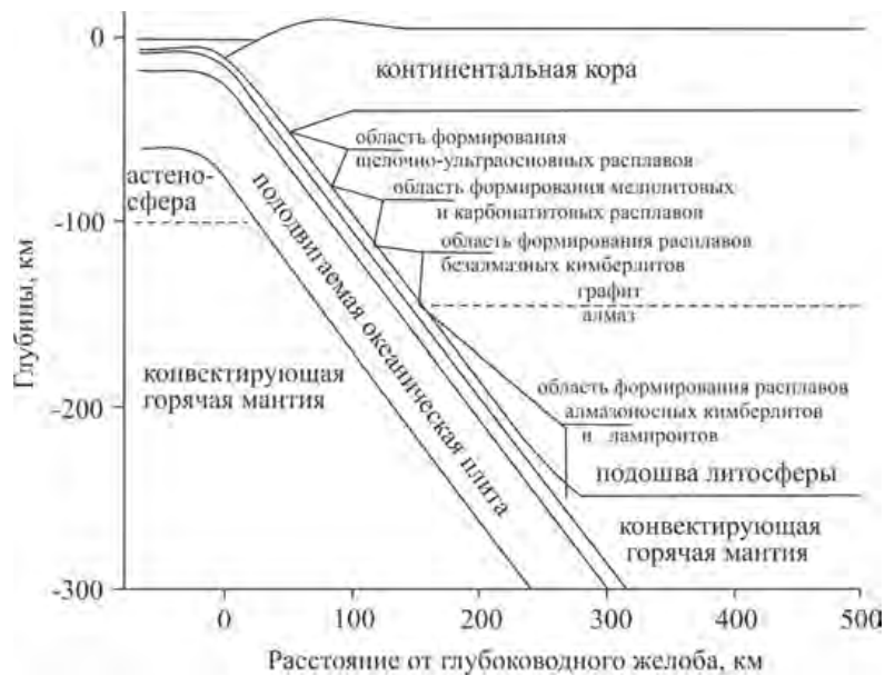
Рис. 6.2. Условия затягивания тяжелых (железистых) осадков по раннепротерозойским зонам поддвига плит на большие глубины (до 250 км) под архейские континенты и области формирования расплавов глубинных пород (Сорохтин и др., 2004)
