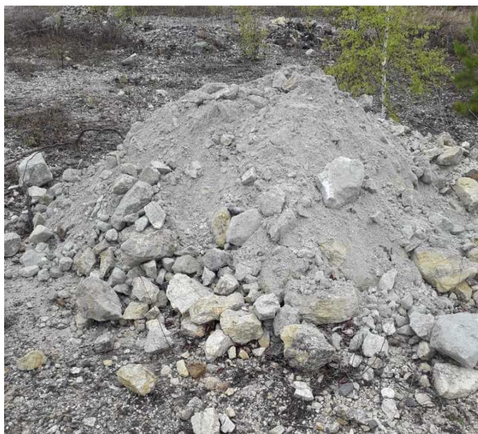
Рис. 5. Гранулометрический состав отвалов из шурфа на поверхности отвалов. Видна высокая степень выветрелости обломков
