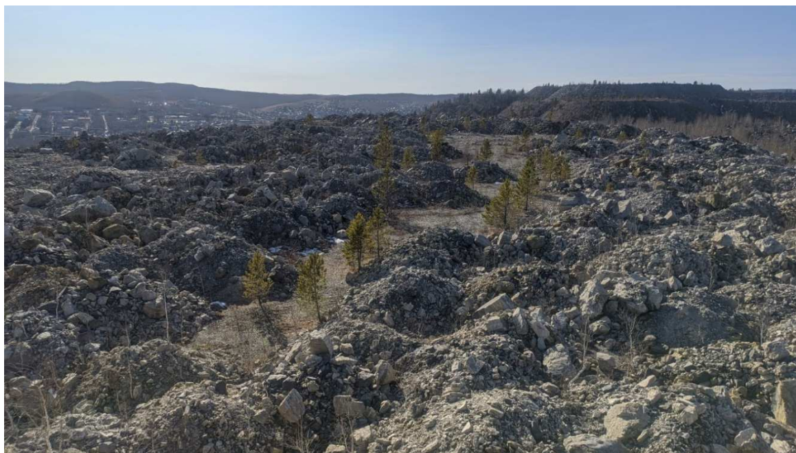
Рис. 6. Завал поверхности отвалов негабаритными глыбами
