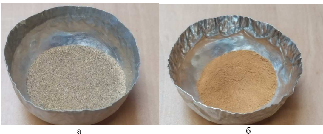
Рис. 3. а – исходный лейкоксеновый концентрат; б – продукт после обжига
