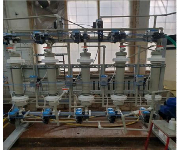
Фото 3. Автоматизированный узел сорбционного извлечения РЗМ, производительность по растворам 90-120 л/час
