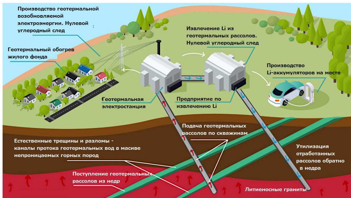
Рис. 5. Концепция комплексного освоения литиевых геотермальных ресурсов компаниями Cornish Lithium и Geothermal Engineering Limited (графство Корнуолл, Великобритания) [30]
