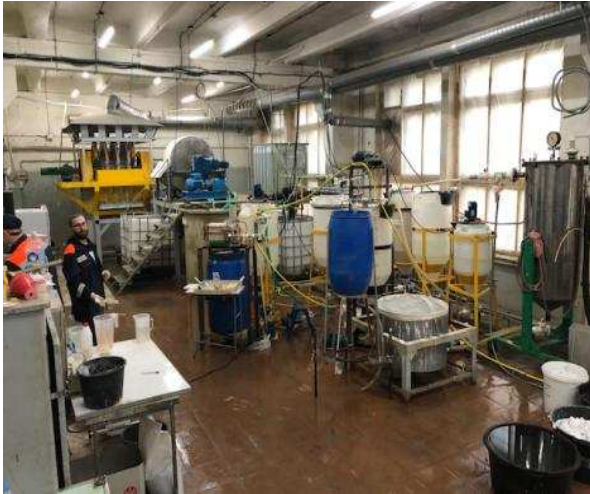
Фото 2. Опытно-промышленная установка по переработке ФПГ. Производительность по ФПГ – 2т/сутки, по ГРЗК – 7-8 кг/сутки
