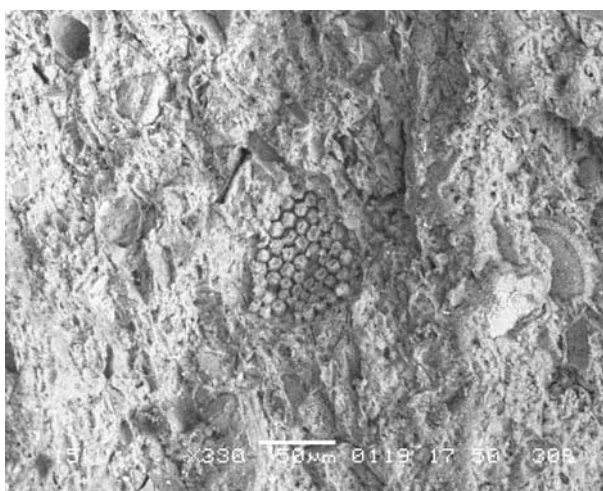
Рис. 7.9. Электронномикроскопические снимки киевской опоки с колониальными организмами, обр 10/21 а - увеличение 330, б- 1900.
