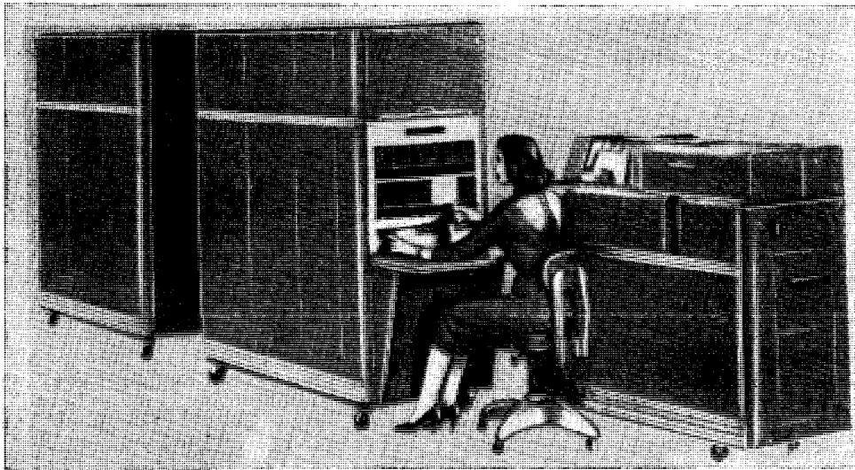
Рис. VI. 76. Электронная вычислительная машина «IBM 650» с вводом программы и данных на магнитный запоминающий барабан состоит из трех элементов. В одном шкафу помещаются вводное и выводное устройство, в двух других — запоминающее и вычислительное устройства. Запоминающее устройство имеет 20000 ячеек.
