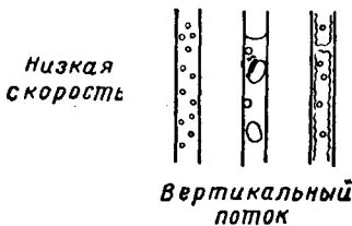
Рис. VII. 13. Структура двухфазного потока.
