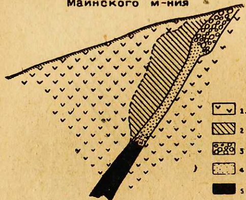
Рис. 8. 1—Вмещающий руду рассланцованный порфирит, 2—порфирит, выбеленный серной кислотой в зоне окисления и цементации, 3—железняки и охры, 4—пески зоны выщелачивания, 5—первичные серноколчеданные руды.
