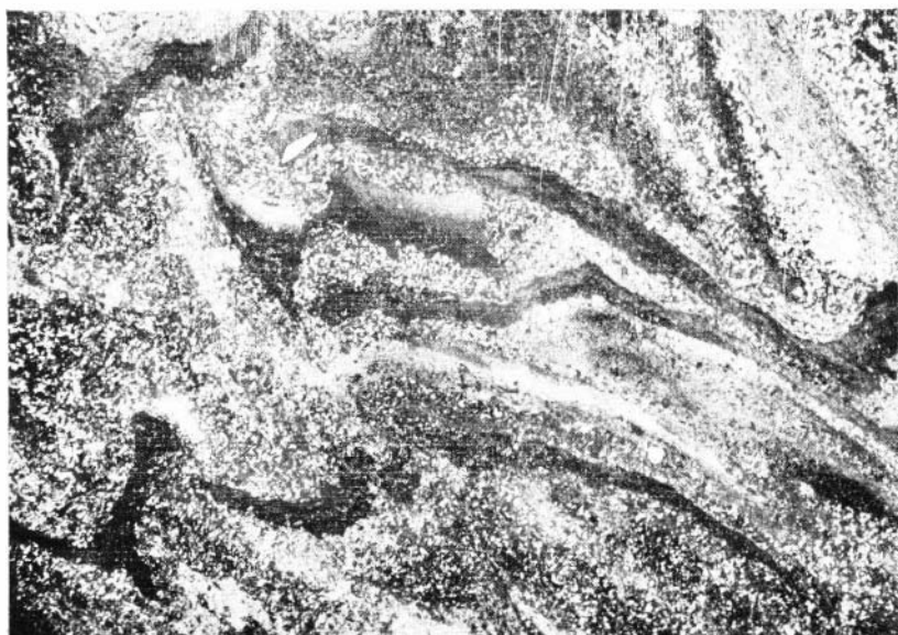
Фото 5. Алевроитовый аргиллит железистый. Фрагмент микрополидисперсной текстуры. Непрозрачные минералы — обломки железорудных минералов (гематит, магнетит). Прозрачные — главным образом кварц и белая слюда. Бикская свита, р. Белая. \times 12 . Николи —, Обр. 5025—7.
