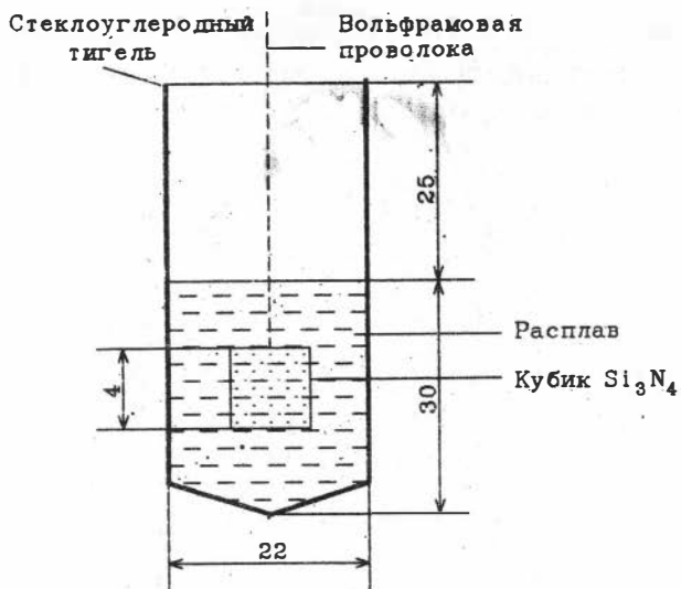
Рис. 22. Схема сборки опыта по растворению зерна нитрида кремния. Размеры даны в миллиметрах.
