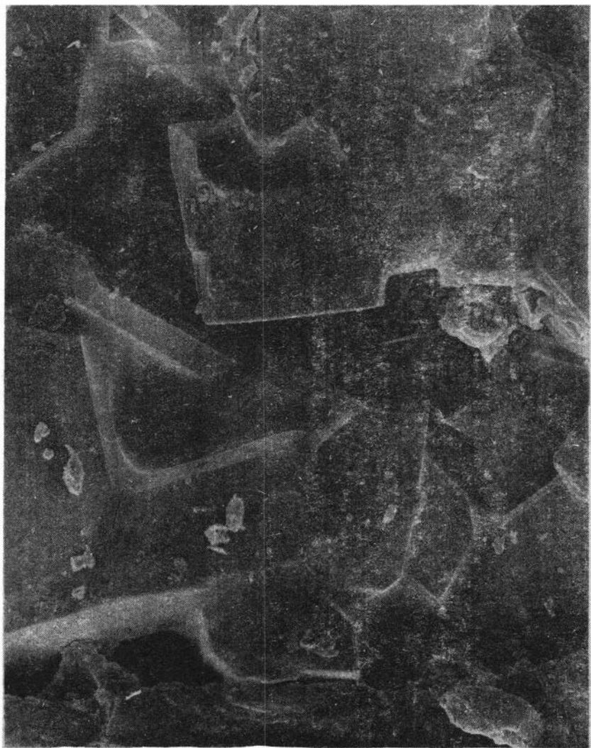
Рис. 24. Кристаллизация оливина на поверхности стекла состава: 10 мас.% CaO, 30 мас.% MgO, 15 мас.% Al 2 O 3 , 45 мас.% SiO 2 . Увеличение x 900.
