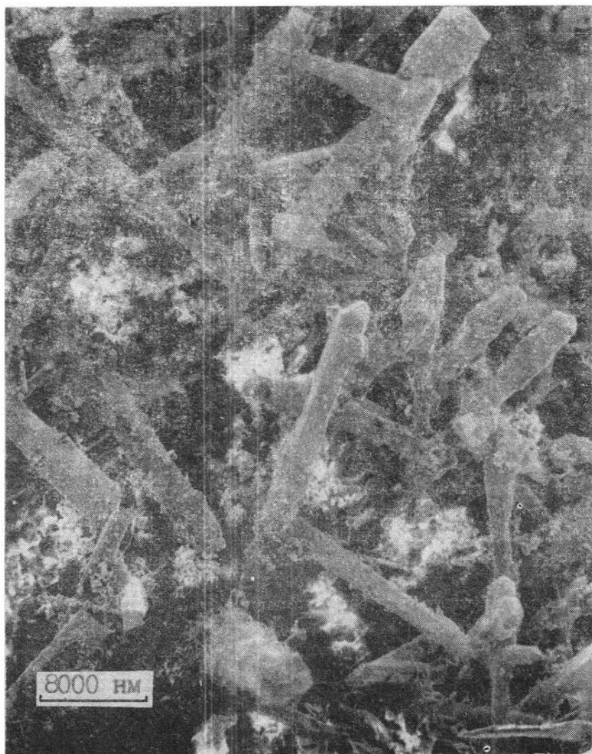
Рис. 29. Игольчатые кристаллы перекристаллизованного оливина на поверхности шихты. Увеличение \times 2100 .
