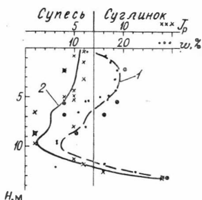
Рис. 5. Изменение с глубиной природной влажности w (1) и числа пластичности I_p (2) грунтов ЗМС площадки полигона. Большие точки соответствуют образцам из скважин 10—12 вблизи вибраторной группы (см. рис. 2).
