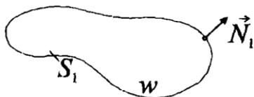
Рис. 6.1. Объём, ограниченный замкнутой поверхностью
