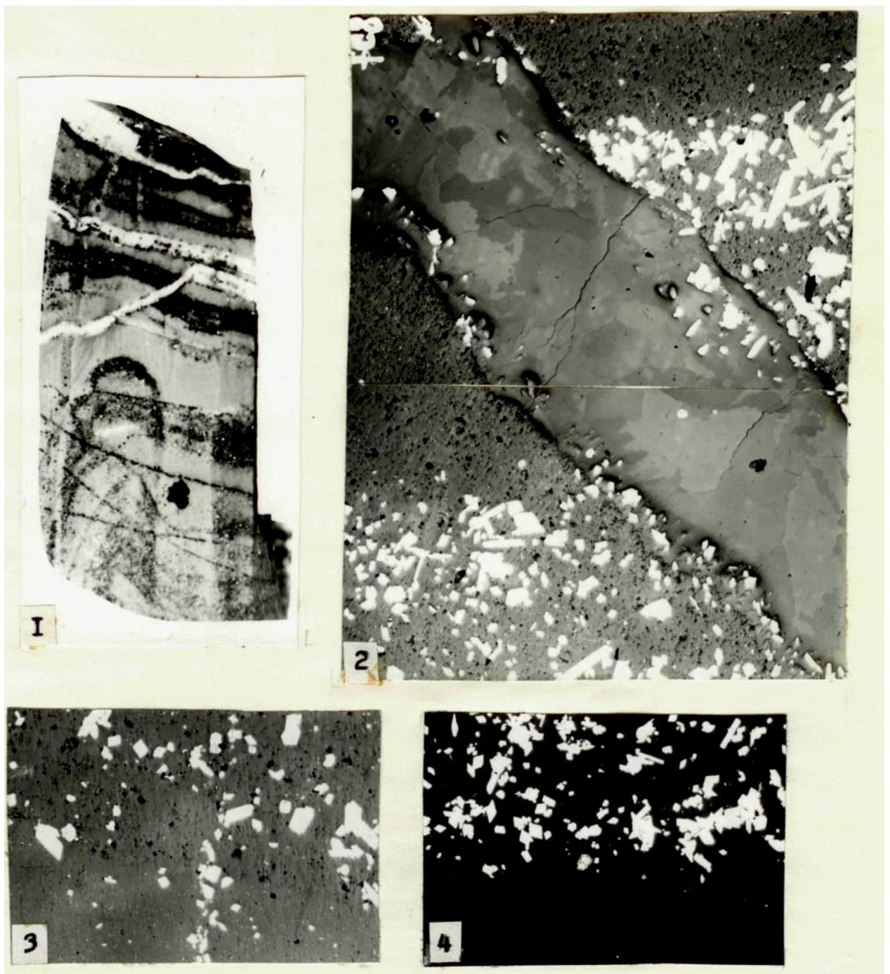
Рисунок 7 - сочетание послойной и прожилковидной тонкой вкрапленности сульфидов в околожильных базальтах. Увел.2; 2 -то же, что и на фото I. Шлиф полир., увел.50; 3,4 - послойная вкрапленность сульфидов, приуроченная к благоприятному прослою алевропесчаников. Шлифы полир., увел.50. Месторождение Бестобе.
