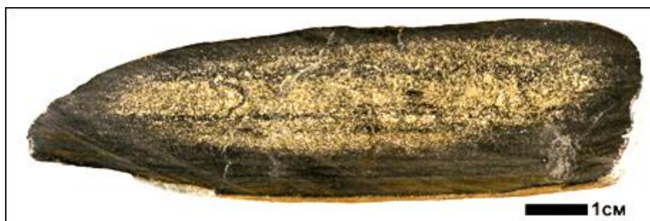
Рисунок 53 - Будина с зональным распределением пирит-арсенопиритовой минерализации, наложенной на параллельно-слоистую породу. Образец.
