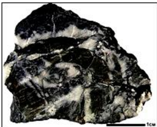
Рисунок 49 - Зона смятия с максимальным преобразованием углеродистого вещества в зеркалах скольжения. Пришлифовка.
