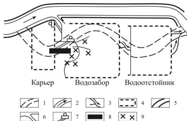
Рис. 63. Изменение морфодинамического типа русла реки на участке дражного полигона (Ленский район): 1 – естественное русло реки; 2 – техногенное русло; 3 – сток отработанной воды в русло; 4 – водозадерживающие дамбы; 5 – водонаправляющие дамбы; 6 – водозабор; 7 – водонасосы; 8 – промприбор; 9 – техногенные отвалы.
