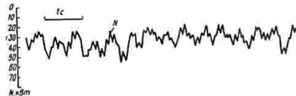
Рис. 41. Осциллограмма с записью мощности, потребляемой приводом исполнительного органа комплекса КН-5Н
