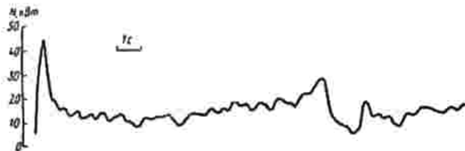
Рис. 30. Осциллограмма мощности, потребляемой электродвигателем привода хода самоходной вагонетки, при транспортировании груза массой 3 т
