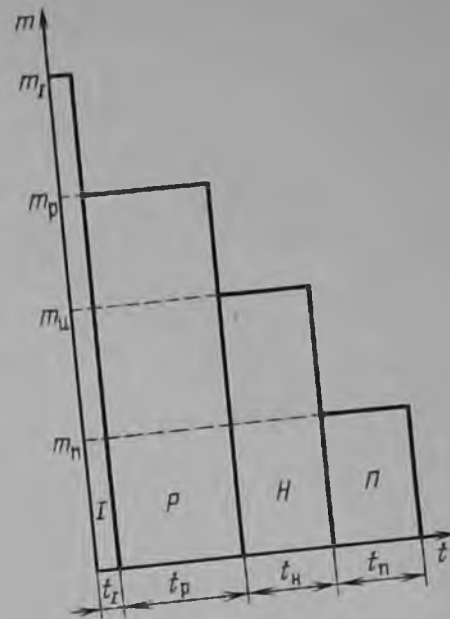
рис. 37. Плановый режим нагружения выемочной машины, работающей по односторонней схеме
