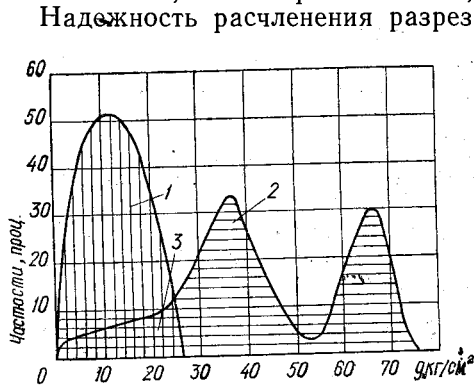
Рис. 40. Оценка надежности выделения слоев с различным сопротивлением зондированию:
