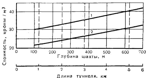
Рис. 5. Зависимость стоимости разработки подземных выработок от глубины их залегания:
