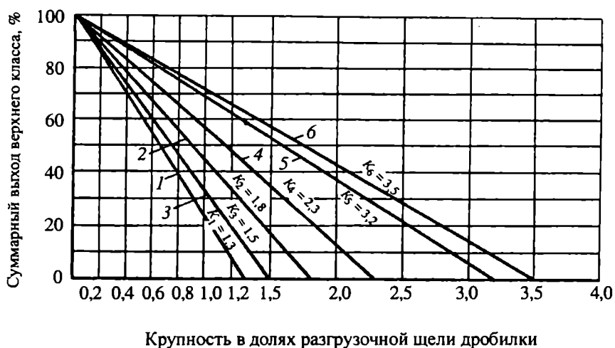
Рис. 4.8. Аппроксимированные характеристики крупности продуктов дробления для различных типов дробилок: щековые дробилки: 1 — типа ЩДС, 2 — типа ЩДП; конусные дробилки: 3 — КСД-1750Гр и КСД-2200Гр, 4 — КСД-176ОТ и КСД-220ОТ, 5 — КМД-1750Гр и КМД-220ОТ, 6 — КМД-175ОТ и КМД-220ОТ
