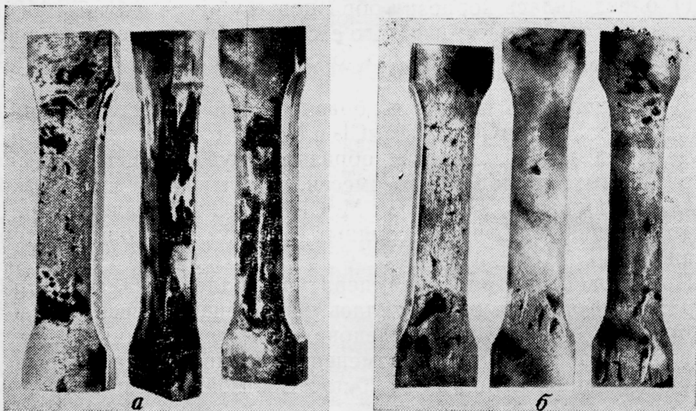
Рис. 16. Виды коррозии образцов труб, находившихся длительное время в солевой среде:
