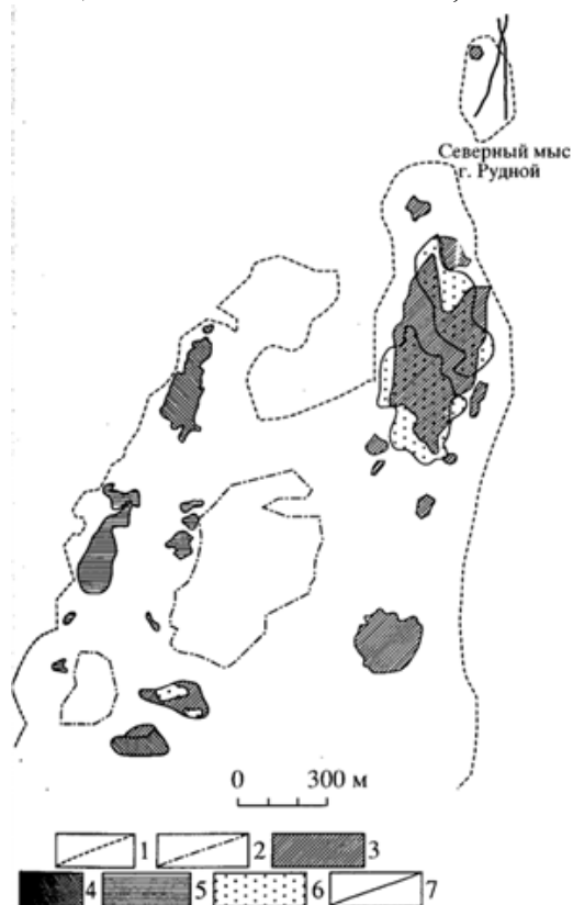
Рисунок 5. Схема размещения тел массивных сульфидных руд в интрузиве Норильск I: 1 – контур интрузива с вкрапленным медно-никелевым оруденением; 2 – контуры участков интрузива, лишенные сульфидного оруденения; 3-6 – субсогласные с интрузивом тела массивных сульфидных руд: пирротинового (4), пирротин- халькопиритового (5), халькопирит-кубанитового (6) и халькопиритового (7) состава; 7 – вертикальные сульфидные жилы
