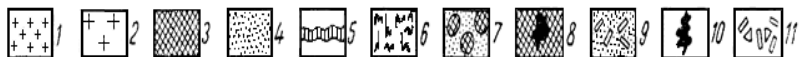
Рисунок 5.1. Схема текстурно-парагенетических типов пегматитов. (По К. Власову): 1 – граниты; 2 – пегматоидные граниты; 3 – микроклин; 4 – кварц; 5 – контактовые оторочки и зоны мусковит-кварц-полевошпатового состава; 6 – пегматиты письменной и гранитной структуры; 7 – блоковая зона; 8 – мономинеральная микроклиновая зона; 9 – кварц-сподуменовая зона; 10 – комплексы и зоны замещения: альбит, кварц, мусковит, реликты микроклина, редкометальные минералы; 11 – сподумен. I – равномернoзернистый или письменный; II – блоковый; III – полнодифференцированный; IV – редкометалльного замещения; V – альбит-сподуменовый типы
