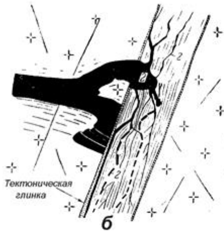
Рисунок 2.14. Характер изменения жилы около контакта с дорудной трещиной (По Т. М. Кайковой): а – дорудная преграждающая трещина малой мощности; местами присутствует тончайший слой тектонической глины; зона рассланцевания вдоль трещины мощностью не более 10 см. Тонкие прожилки кварца проникают вдоль трещины по сланцеватости пород. Тонкий прожилок (1), сопутствующий жиле, «отклоняется» дорудной трещиной; б – слой тектонической глины достигает 10 мм мощности. В дорудную зону по сланцеватости проникает кварц и главным образом кальцит (2). Жила упирается в зону нарушения, не продолжаясь за последнюю.
