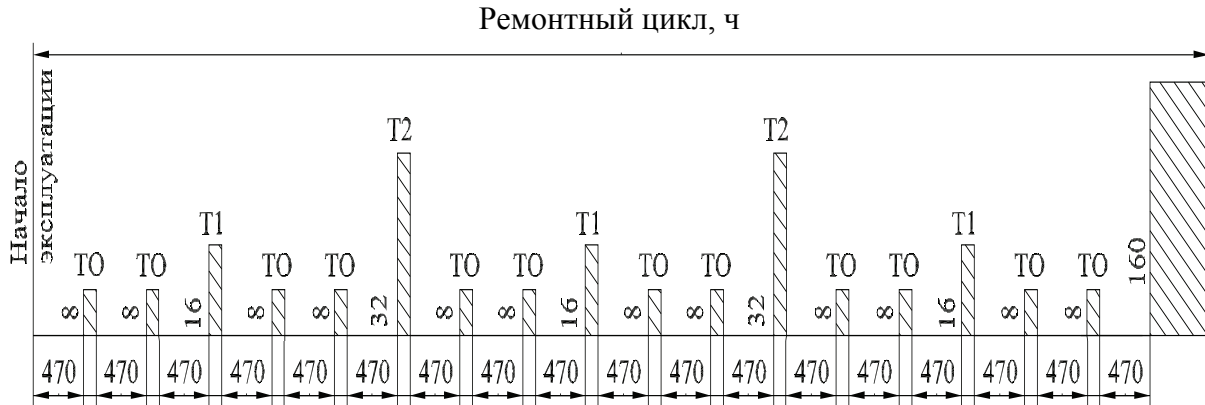
Рис. 6.1. Структура ремонтного цикла для самосвального автопоезда: ТО – технический осмотр, выполняемый через 470 ч работы, продолжительностью 8 ч (с остановкой оборудования); Т1 – первый текущий ремонт, выполняемый через 1 410 ч, продолжительностью 16 ч; Т2 – второй текущий ремонт, выполняемый через 2 820 ч работы, продолжительностью 32 ч; К – капитальный ремонт, выполняемый через 8 460 ч, продолжительностью 160 ч
