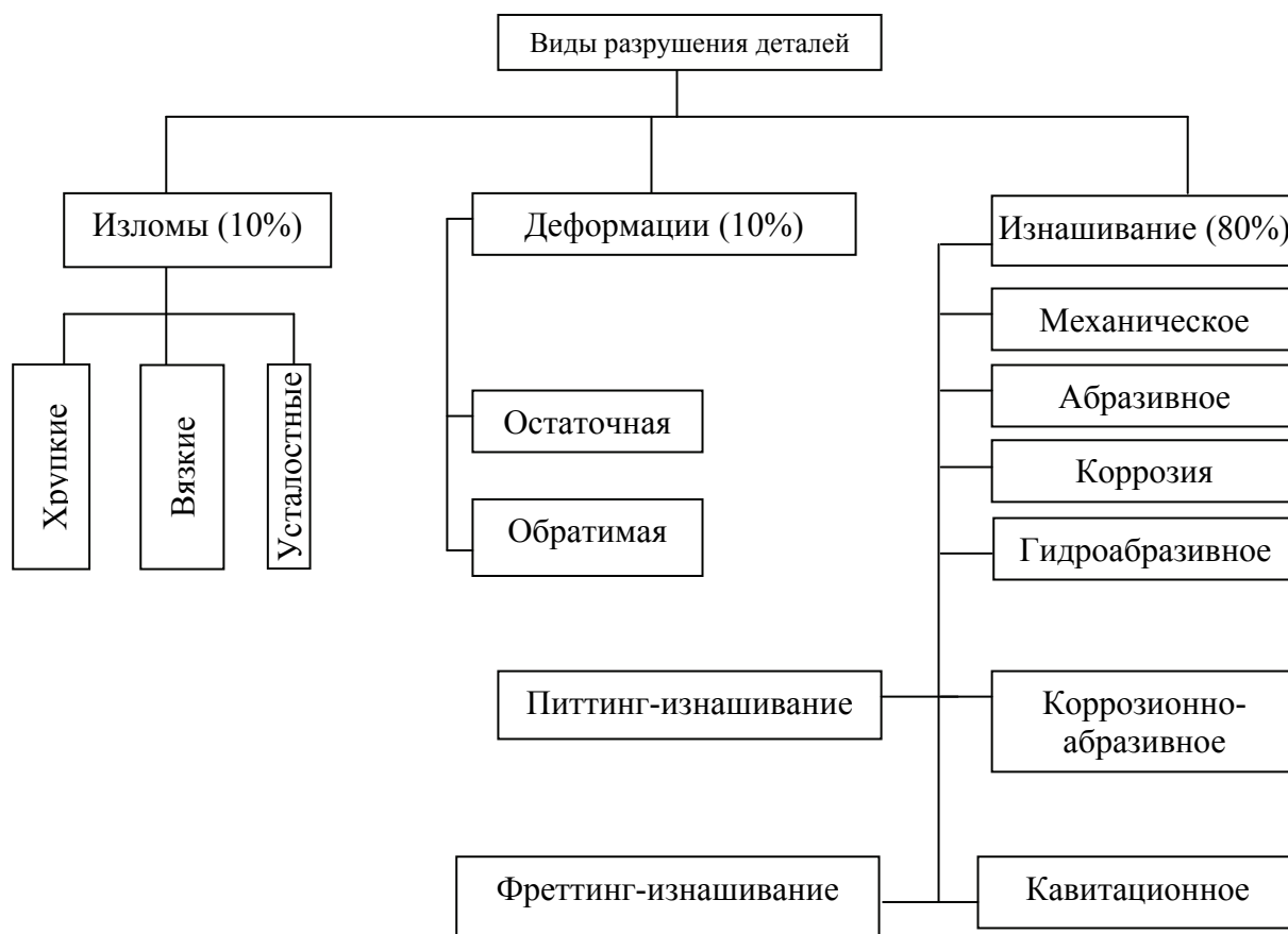
Рис. 4.1. Классификация видов разрушения деталей
