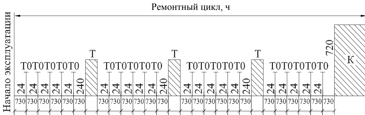
Рис. 6.2. Структура ремонтного цикла электродуговой печи
