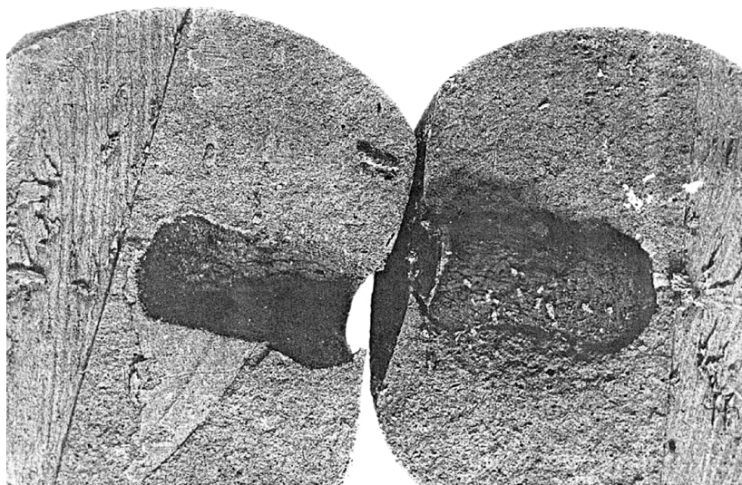
Рис. 4.15. Разрез колбы с цементным раствором
