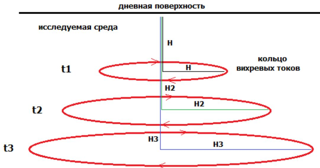
Рисунок 2.11 – Схема распространения вторичного ЭМ поля в среде
