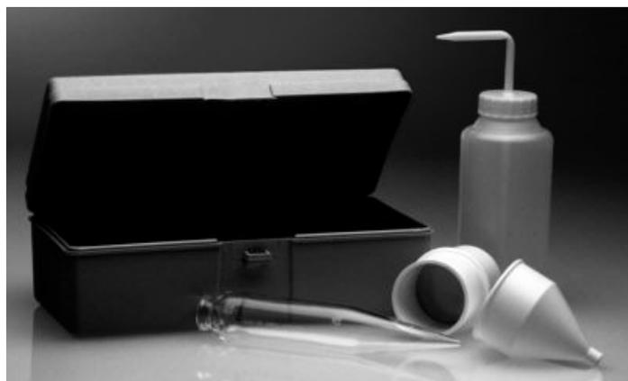
*Рисунок IV-1:* Набор FANN для определения содержания песка в буровом растворе.
