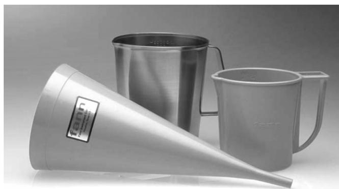
*Рисунок II-2:* Пластиковый вискозиметр Марша FANN с мерными кружками.
