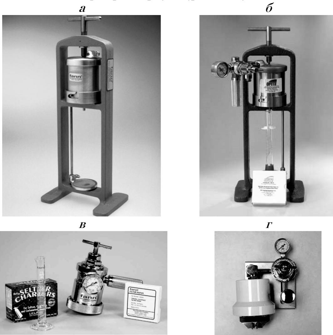
Рисунок III-1: Фильтр-прессы низкого давления FANN (а, в) и OFITE (б, г) с полноплощадным фильтром (а, б) и полуплощадным фильтром (в, г).
