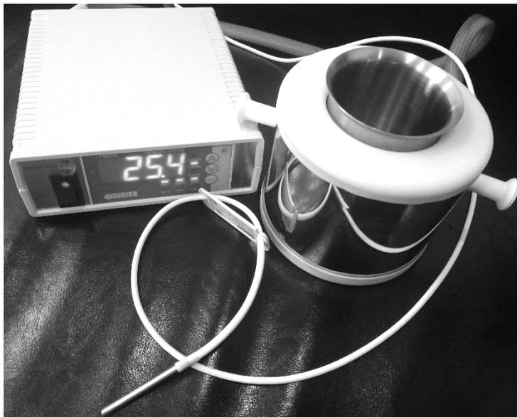
*Рисунок II-4: Терморегулятор ТРП-120-ТС (НИИЦ «Недра-тест», Москва) для вискозиметров Fann 280, OFITE 800, OFITE 900*
