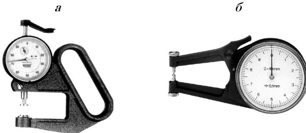
Рисунок III-2: а – толщиномер; б – кронциркуль.
