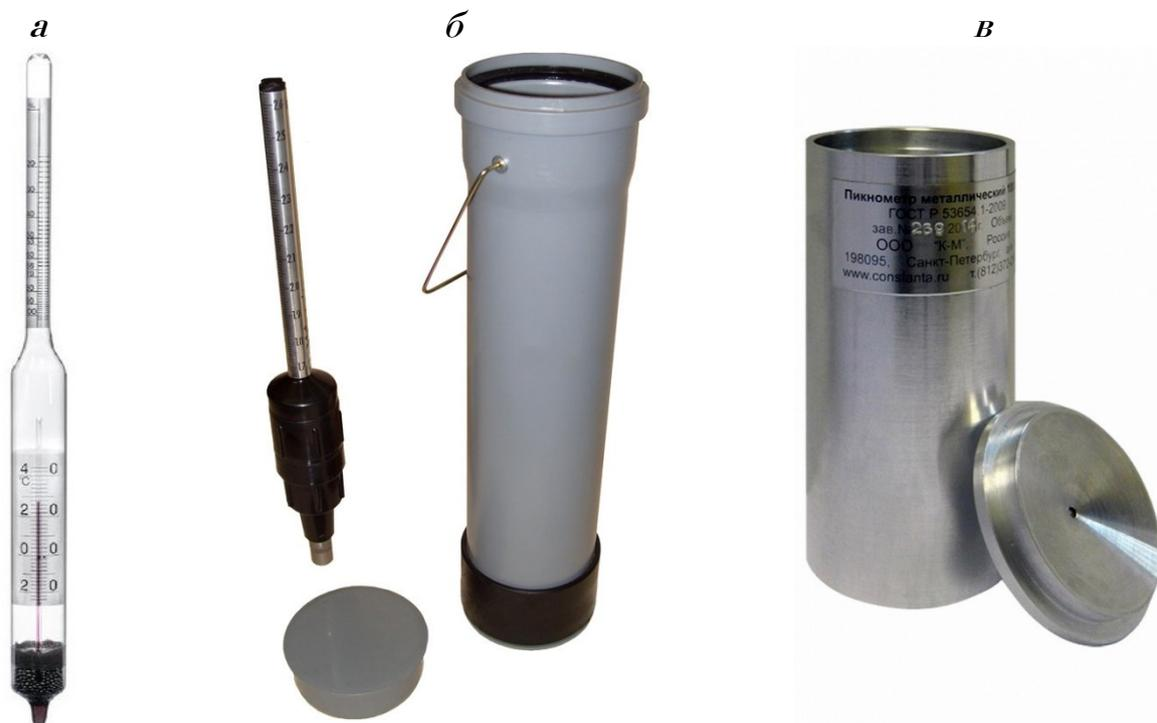
*Рисунок 1-1: а — стеклянный ареометр для определения плотности однородных жидкостей; б — ареометр для промывочных жидкостей; в — стальной пикнометр.*
