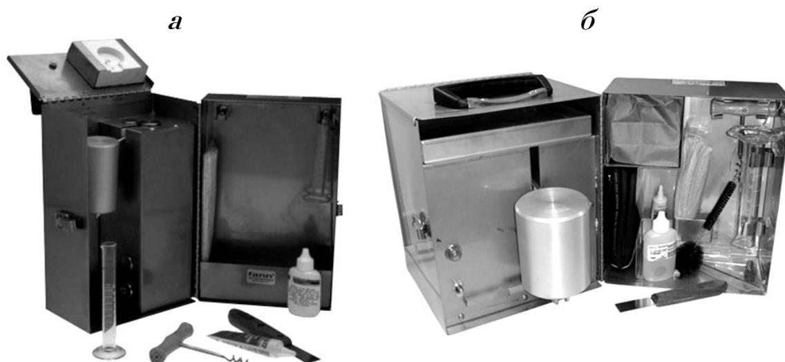
*Рисунок V-1:* Наборы для разгонки FANN с объемом реторты 10 мл (*а*) и 50 мл (*б*).
