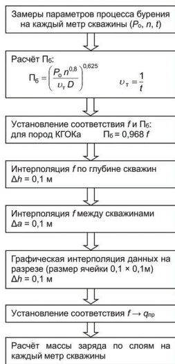
Рисунок 11.2. Схема построения цифровой модели крепости горных пород
