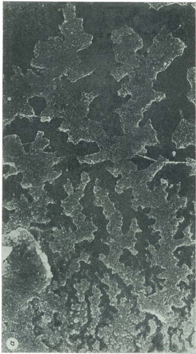
Фото 15. Дендритные образования на границах «кристаллита» (а — ув. 1300, б — ув. 5000).
