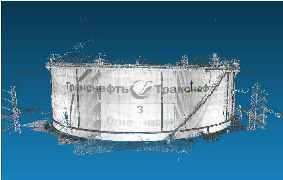
Рисунок 4.24 – Единое облако точек поверхности РВСПА-50000 №3 в программном комплексе LaserControl
