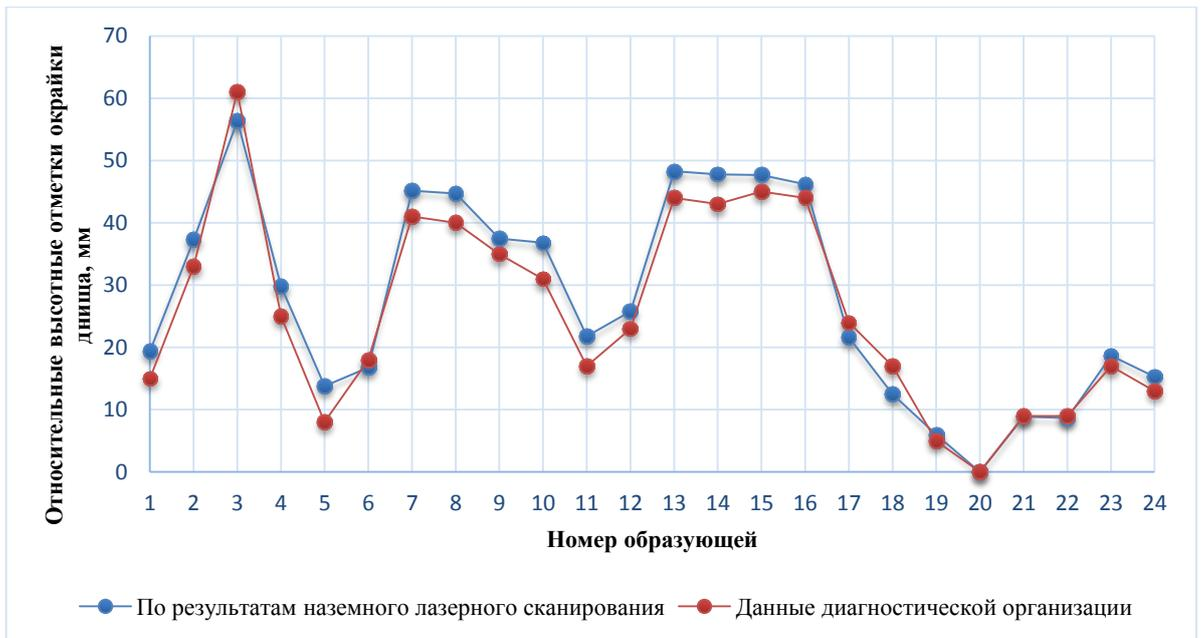
Рисунок 4.12 – График нивелирования окрайки днища РВСП-20000 № 22
