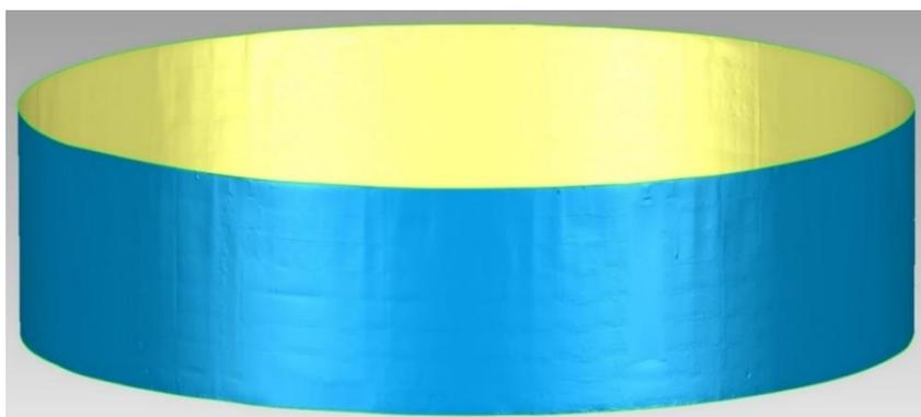
Рисунок 2.15 – Полигональная модель стенки резервуара РВСП-20000
