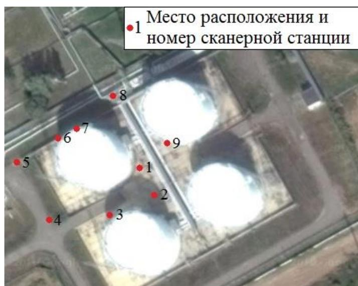
Рисунок 4.16 – Расположение сканируемого резервуара РВСП-7500 №29 и сканерных станций
