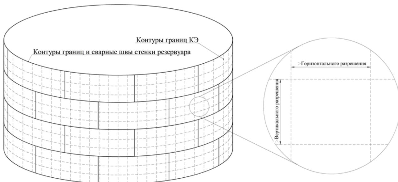
Рисунок 3.4 – Схема аппроксимации поверхности стенки резервуара конечными элементами
