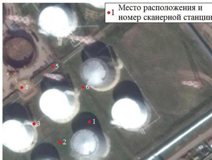
Рисунок 4.1 – Расположение сканируемого резервуара РВСП-5000 №5 и сканерных станций
