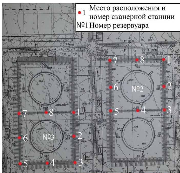
Рисунок 4.22 – Расположение сканируемого резервуара РВСПА-50000 №3 и сканерных станций
