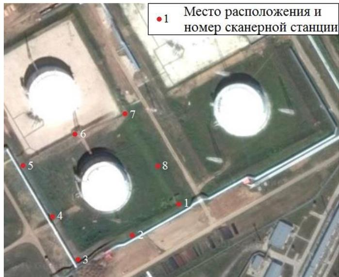
Рисунок 4.9 – Расположение сканируемого резервуара РВСП-20000 №22 и сканерных станций
