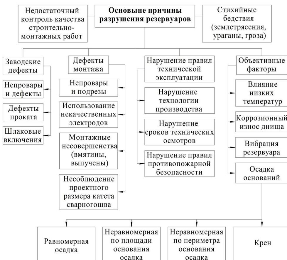
Рисунок 1.2 – Причины разрушения РВС по В.Б. Галееву
