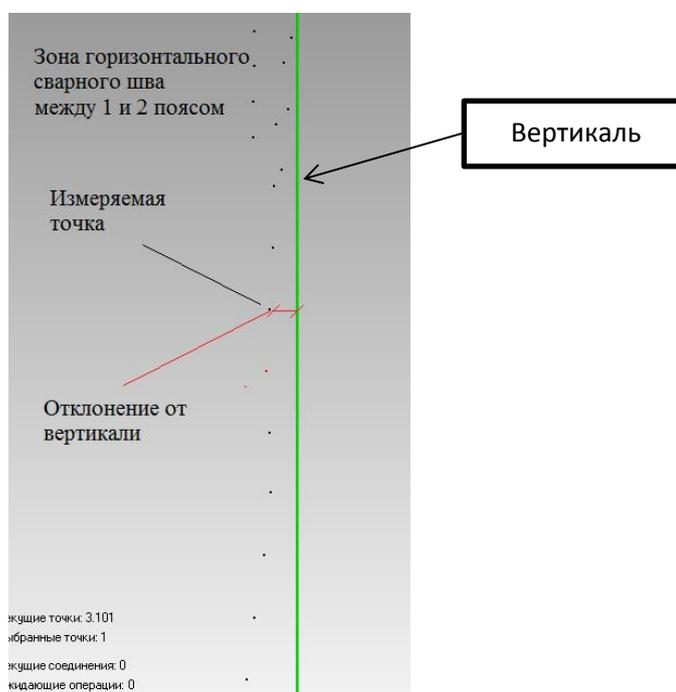
Рисунок 2.14 – Определение отклонений образующей стенки резервуара от вертикали
