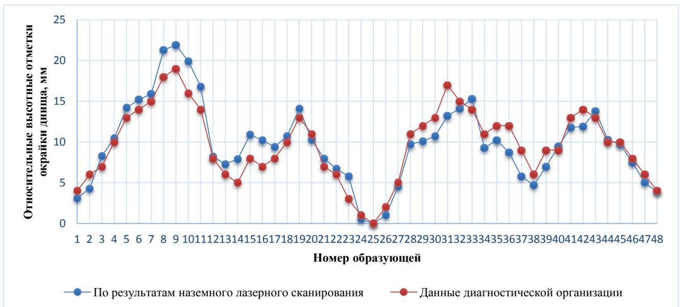
Рисунок 4.25 – График нивелирования окрайки дна РВСПА-50000 №2
