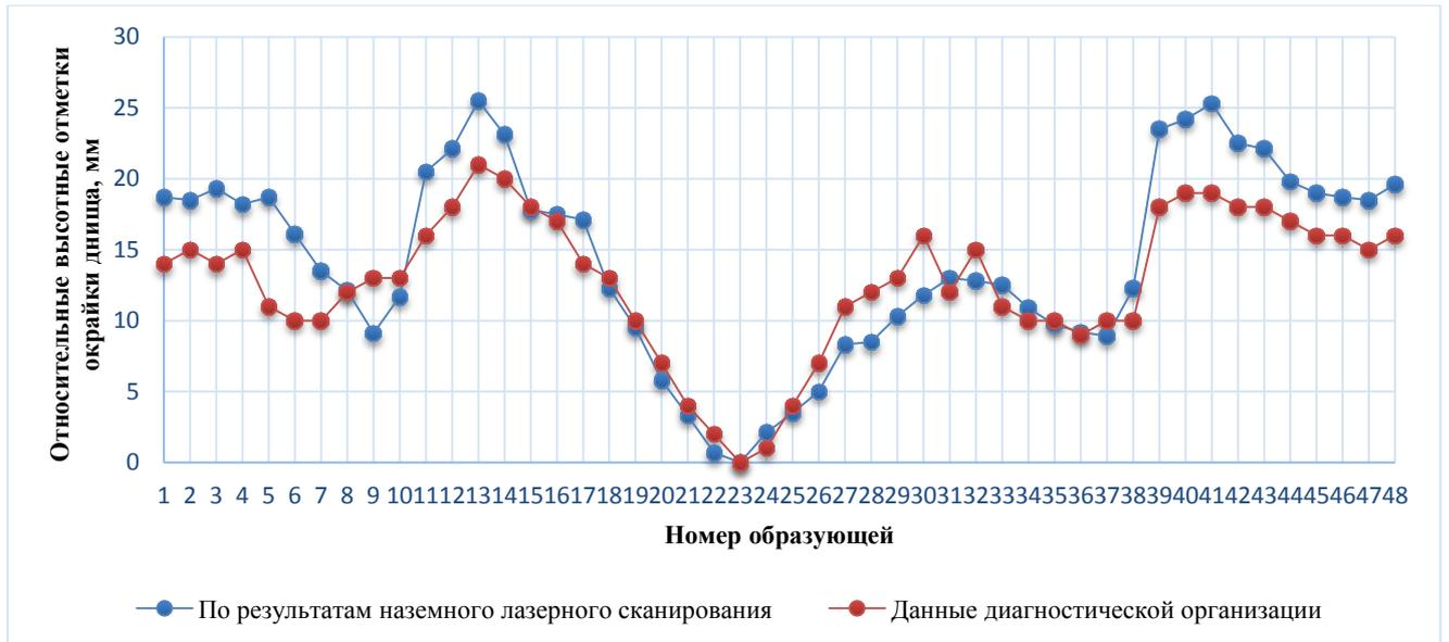
Рисунок 4.26 – График нивелирования окрайки днища РВСПА-50000 №3
