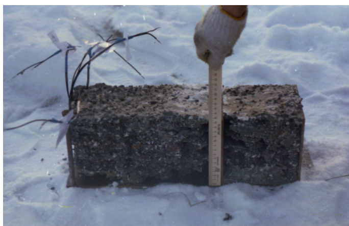
Рисунок 2.6. – Кассета с образцами, сформированными при температуре -24^\circ\text{C} послойным намораживанием.
