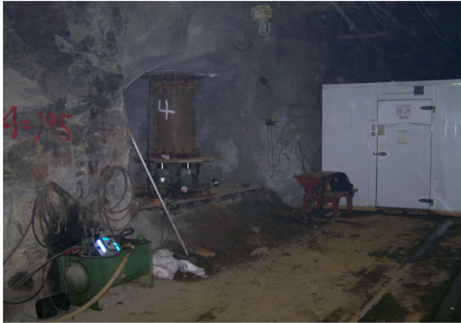
Рисунок 1.2 – Образец смерзшейся смеси, размещенный в нише экспериментальной шахты NORCAT.
