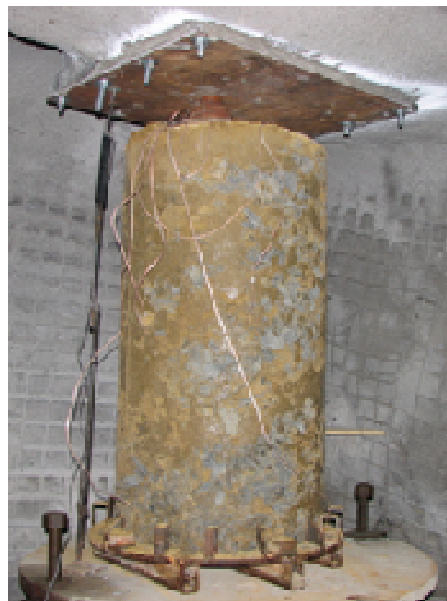
Рисунок 1.3. – Образец смерзшейся смеси перед испытанием на прочность.
