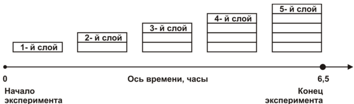
Рисунок 2.11. – Схема динамики формирования и промораживания пятислойного образца.
